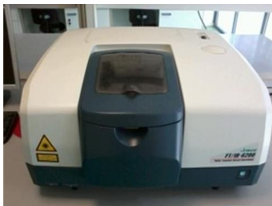
Εικόνα 4.18: Φασματόμετρο μέσου υπερύθρου FT-IR της εταιρίας Jasco.
