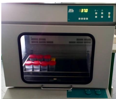
Εικόνα 4.5: Περιστροφικός αναδευτήρας της εταιρείας Edmund Buhler GmbH. Στο εσωτερικό του, τα δείγματα.
