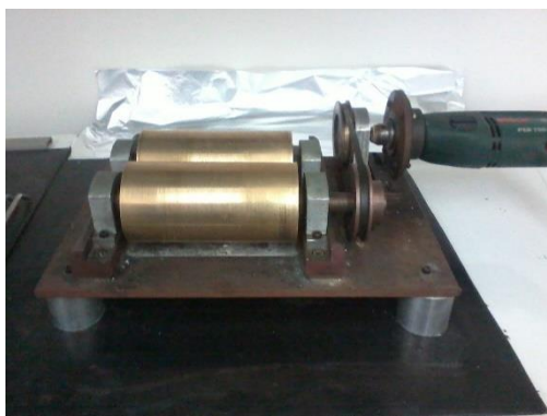
Εικόνα 4.3: Συσκευή περιστρεφόμενων κυλίνδρων για την επίτευξη ταχείας ψύξης τηγμάτων (Μέθοδος Roller Quenching)
