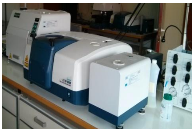
Εικόνα 4.19: Φασματόμετρο άπω υπερύθρου της εταιρίας Jasco.
