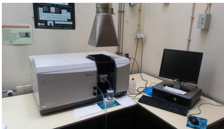
Εικόνα 4.21: Φασματόμετρο ατομικής απορρόφησης της εταιρίας GBC Scientific Equipment- Ananta.
