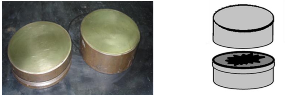
Εικόνα 4.1: Μεταλλικές πλάκες ορείχαλκου για την ψύξη τηγμάτων (αριστερά) – Τήξη με τη διαδικασία splat-cooling. ( 10^3 - 10^4 °C/s)
