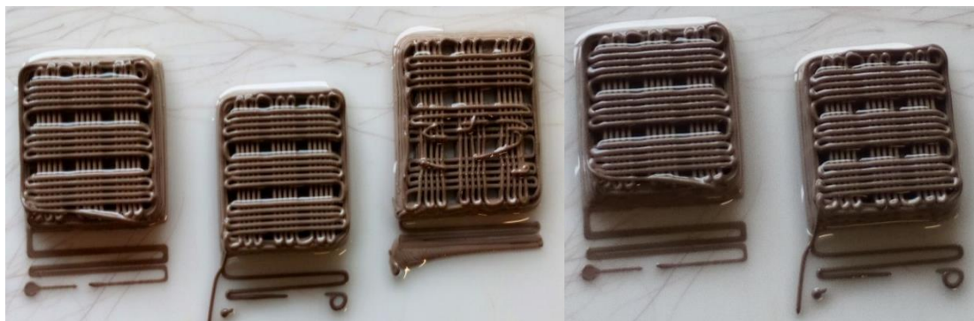
Εικόνα 10.6: Παραγόμενα υλικά με τη μέθοδο Robocasting. Αριστερά: Δοκίμια με μέγεθος πόρων 200 \mu\text{m} . Δεξιά: Δοκίμια με μέγεθος πόρων 300 \mu\text{m} .
