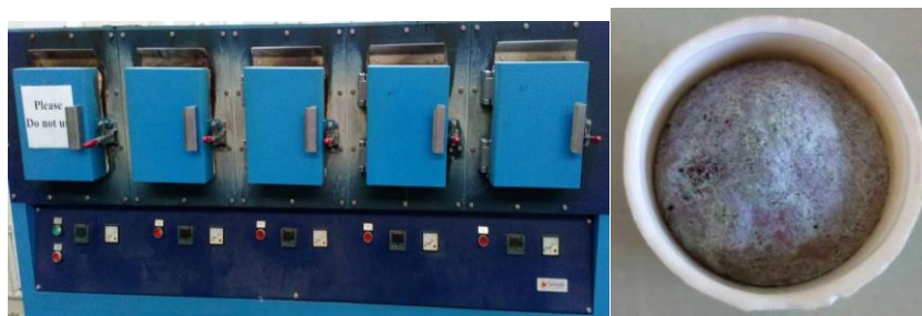
Εικόνα 4.8: (Αριστερά) Φούρνος της εταιρείας Termolab στον οποίο πραγματοποιήθηκε η ξήρανση και η ύαλος μετά από αυτή. (Δεξιά) Οι πρώτες ύλες μετά την ξήρανση σε χωνευτήρι πορσελάνης.
