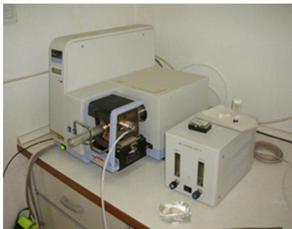
Εικόνα 4.22: Θερμικός αναλυτής DTA/TG της εταιρείας Perkin Elmer.
