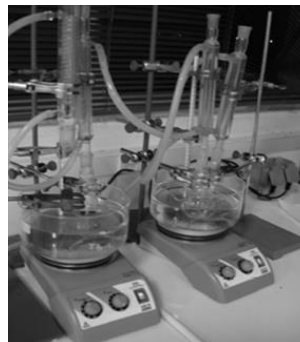
Εικόνα 4.28: Σχηματική αναπαράσταση και πειραματική διάταξη για τη μέτρηση της χημικής ανθεκτικότητας των υάλων
