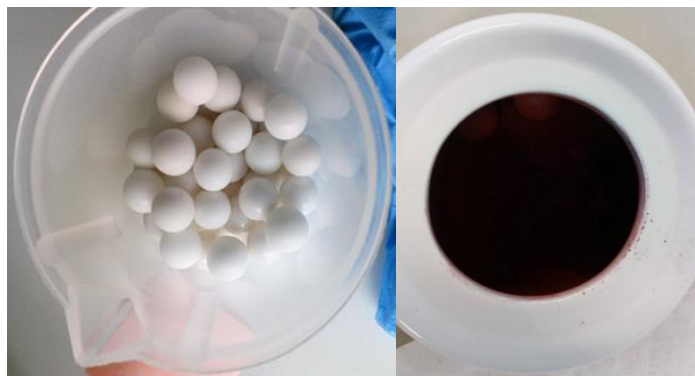
Εικόνα 4.15: Σφαίρες ζirkονίας (αριστερά) και δοχείο πυρωσυσσωματωμένης αλούμινας (δεξιά) μετά την υγρή άλεση.
