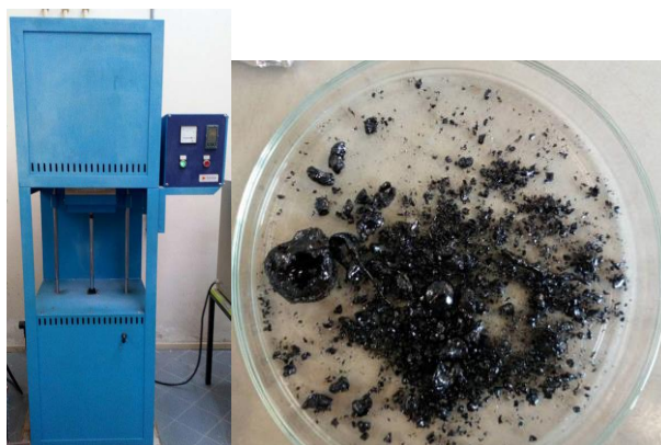
Εικόνα 4.9: Φούρνος της εταιρείας Termolab (αριστερά) στον οποίο πραγματοποιήθηκε η έψηση και η παραγόμενη ύαλος (δεξιά).
