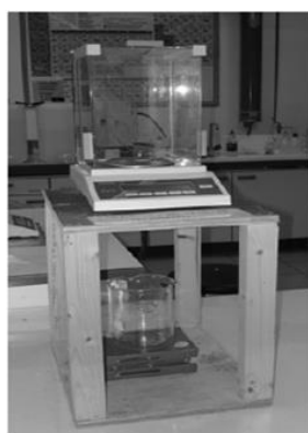
Εικόνα 4.26: Σχηματική αναπαράσταση και πειραματική διάταξη μέτρησης πυκνότητας με τη μέθοδο του Αρχιμήδη.
