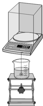
Εικόνα 4.26: Σχηματική αναπαράσταση και πειραματική διάταξη μέτρησης πυκνότητας με τη μέθοδο του Αρχιμήδη.
