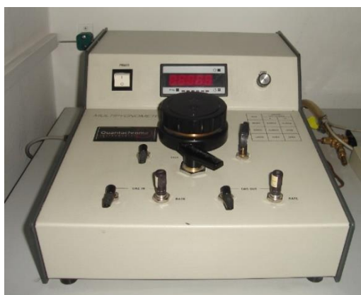
Εικόνα 4.27: Πυκνόμετρο με ροή ηλίου, της εταιρείας Quantachrome.
