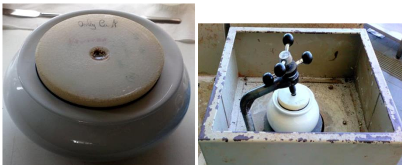
Εικόνα 4.14: Δοχείο πορσελάνης (αριστερά) και μύλος της εταιρείας Ceramics Instruments srl (δεξιά), στον οποίο πραγματοποιήθηκε η ξηρή άλεση.
