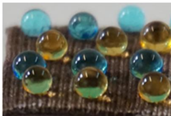
Εικόνα 4.5. Τα υπερυδρόφοβα υφάσματα Zr 4+ - ολεϊκό και Cu 2+ - ολεϊκό δεν διαβρέχονται από νερό και οργανικές βαφές (μπλε του μεθυλενίου και πορτοκαλί του μεθυλίου).
