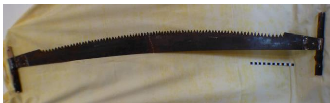
Εικόνα 11 Σάρα. Εργαλείο κοπής δέντρων που χρησιμοποιείται από δύο άτομα.
