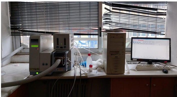
Εικόνα Γ 4.3: συσκευή θερμικής ανάλυσης (DTA/TGA) του τμήματος Μηχανικών Επιστήμης Υλικών του Πανεπιστημίου Ιωαννίνων.
