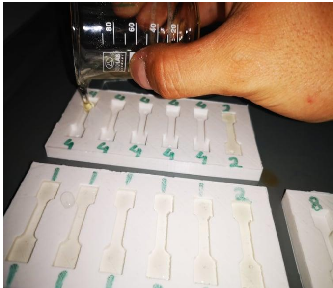
Εικόνα 9. 2 Αφού έγινε η παραγωγή του υδατικού διαλύματος χιτοζάνης-ζελατίνης ιχθύων, έγινε προσθήκη αυτού σε καλούπια σχήματος τρυβλίου Petri (αριστερά) - Αφού έγινε η παραγωγή του υδατικού διαλύματος χιτοζάνης-ζελατίνης ιχθύων, έγινε προσθήκη αυτού σε καλούπια σχήματος T-bone. (δεξιά).
