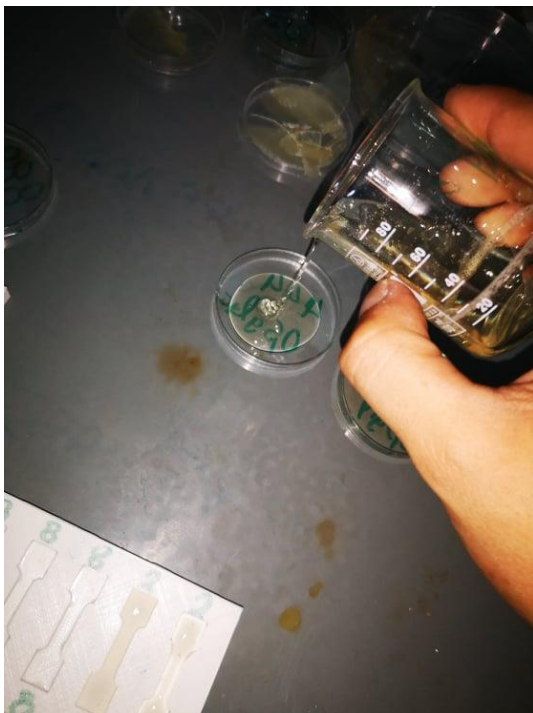
Εικόνα 9. 2 Αφού έγινε η παραγωγή του υδατικού διαλύματος χιτοζάνης-ζελατίνης ιχθύων, έγινε προσθήκη αυτού σε καλούπια σχήματος τρυβλίου Petri (αριστερά) - Αφού έγινε η παραγωγή του υδατικού διαλύματος χιτοζάνης-ζελατίνης ιχθύων, έγινε προσθήκη αυτού σε καλούπια σχήματος T-bone. (δεξιά).
