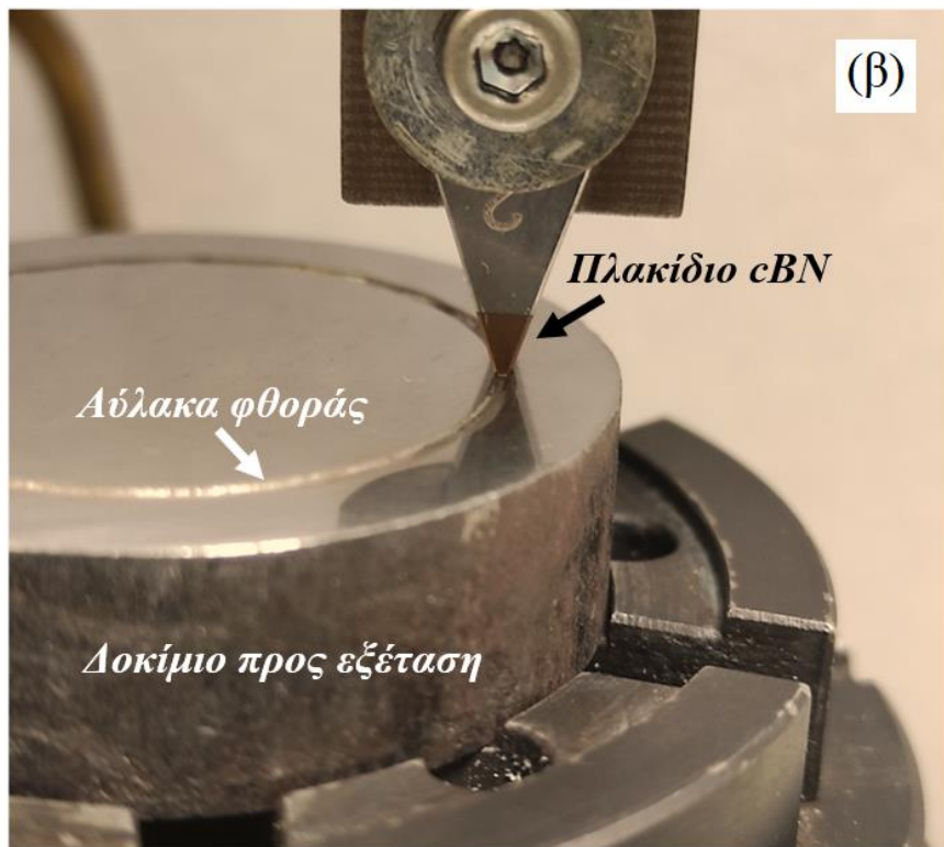
Σχήμα 3.16 Διάταξη τύπου (α) σφαίρας-δίσκου, με σφαίρα Al_2O_3 , (β) στυλίσκου-δίσκου, με κοπτικό άκρο τόνρευσης με επικάλυψη c-BN.
