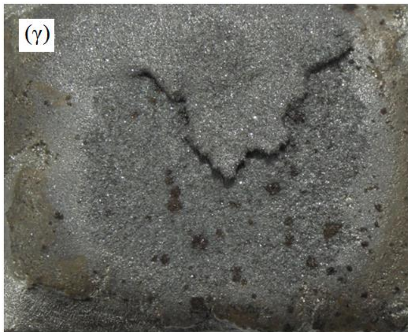
Σχήμα 4.4 (α) Εξέλιξη της θερμοκρασίας της κατεργαζόμενης επιφάνειας. (β) Επιφάνεια με διάσπαρτους πόρους και ρωγμές. (γ) Αποφλοίωση της επιφάνειας (μακρογραφίες). Αφορά την ακτινοβόληση δοκιμίων με εναπόθεση κόνεως TiC.
