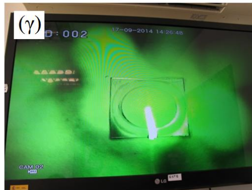
Σχήμα 3.15 Η «ηλιακή» κατεργασία, για τη δημιουργία σύνθετων επιφανειακών στρωμάτων με διασπορά καρβιδίων σε χαλύβδινη μήτρα, περιλαμβάνει δύο εξίσου σημαντικά στάδια: Τοποθέτηση του δοκιμίου στο θάλαμο δοκιμών (α) έλεγχος της θέσης στην περιοχή εστίασης και (β) τοποθέτηση του διαφανούς θόλου και σφράγιση του θαλάμου για τον έλεγχο της ατμόσφαιρας της κατεργασίας. Έκθεση της προς κατεργασία επιφάνειας σε ηλιακή ακτινοβολία: (γ) βιντεοσκόπηση των πειραμάτων και (δ) έλεγχος των παραμέτρων εργασίας (π.χ. άνοιγμα περσίδων) και συνεχής καταγραφή της θερμοκρασίας της κάτω επιφάνειας του δοκιμίου κατά την κατεργασία.
