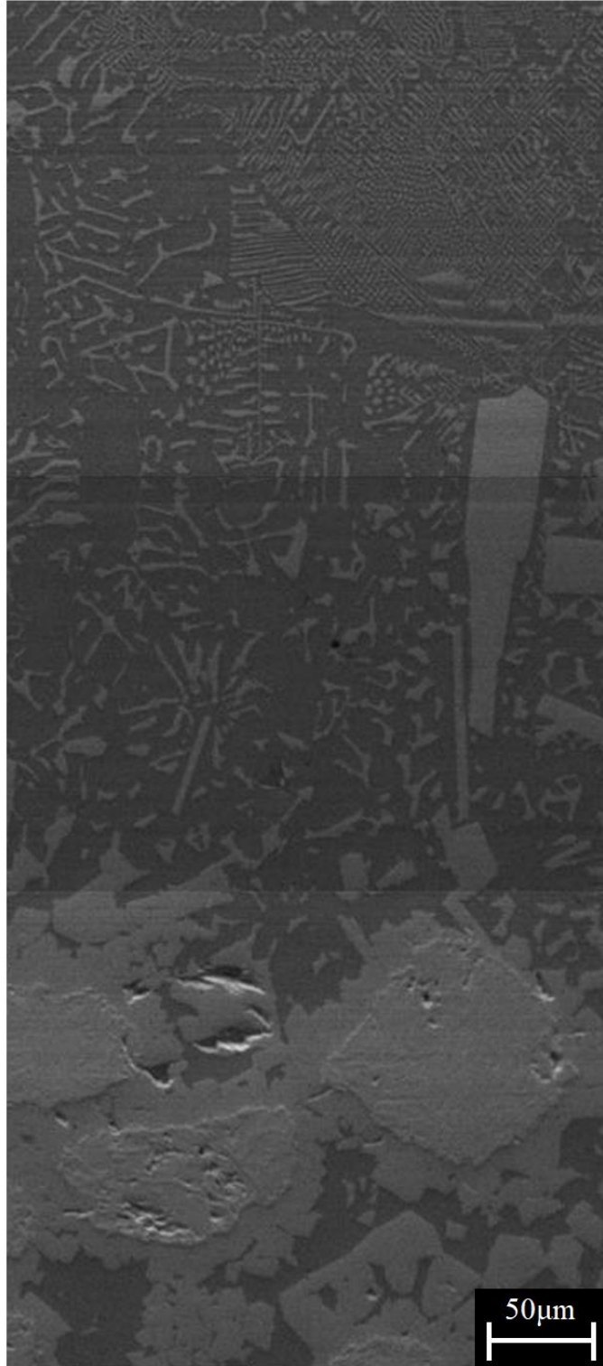
Σχήμα 6.14 Μεγέθυνση στην ανώτερη ζώνη (εξωτερική περιοχή) του «ηλιακού επιφανειακού στρώματος, όπου διακρίνεται η ύπαρξη σχηματισμών διαφορετικής μορφολογίας εντός της μεταλλικής μήτρας (εικόνα ηλεκτρονικού μικροσκοπίου σάρωση).
