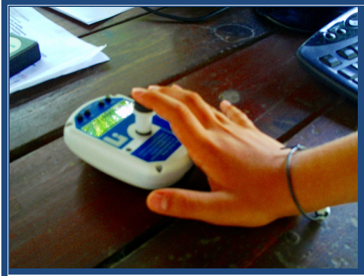
Εικόνα 26 : Εφαρμογή δύναμης – πίεσης στο δυναμόμετρο.
