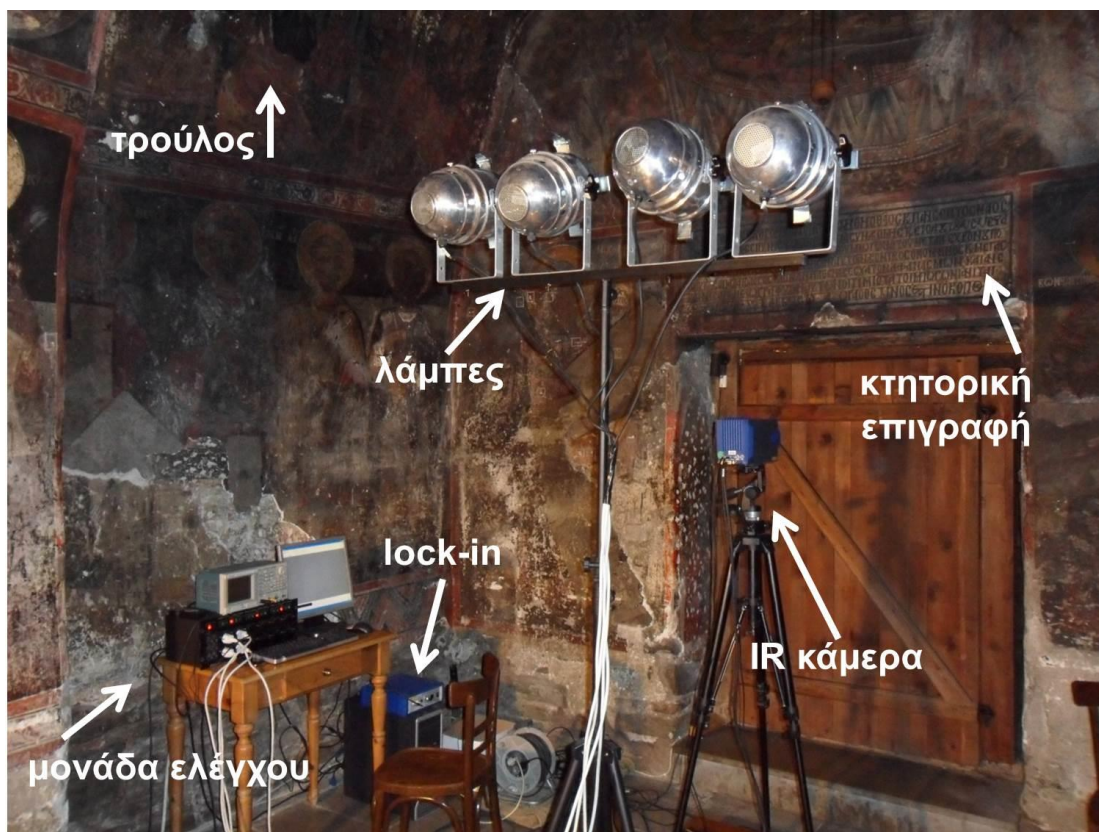
Εικόνα 3.4.13. Πειραματική διάταξη για την αξιολόγηση βλάβης μνημείων πολιτιστικής κληρονομιάς
