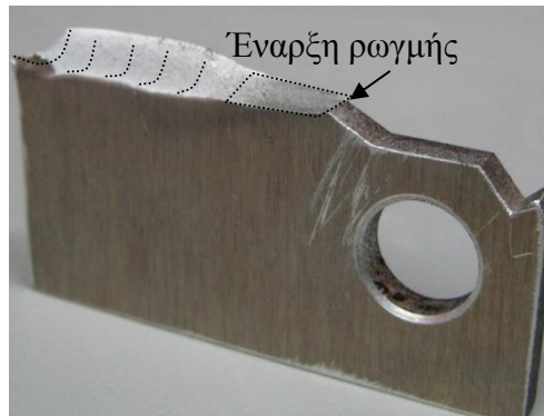
Εικόνα 3.1.27. Δοκίμιο μετά την αστοχία
