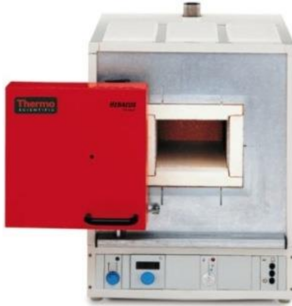
Εικόνα 3.1.5. Φούρνος υψηλών θερμοκρασιών
