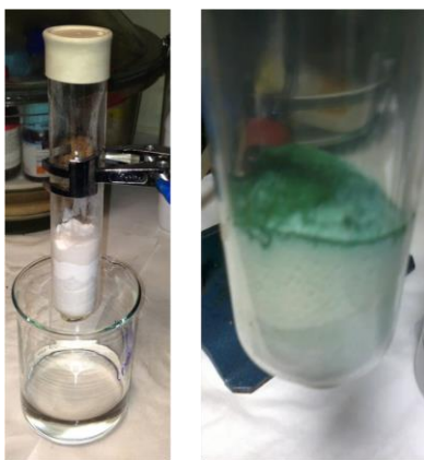
Σχήμα 4.20: Η διαδικασία καθαρισμού του διαλύματος από τα προϊόντα χαλκού με την χρήση οξικής αλούμινας ώστε να προκύψει το καθαρό επιθυμητό πολυμερές.
