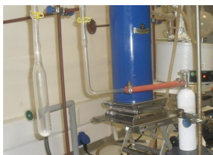
Σχήμα 4.7: Απεικόνιση οβίδας αιθυλενοξειδίου (δεξιά), και αμπούλας που περιέχει CaH_2 (αριστερά).
