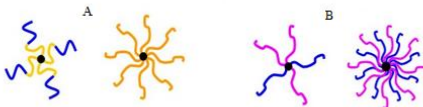
Σχήμα 2.27: A: Αστεροειδή συμπολυμερή και ομοπολυμερή τα οποία αποτελούνται από πανομοιότυπους κλάδους. B: μικτόκλιωνα αστεροειδή πολυμερή 97 .
