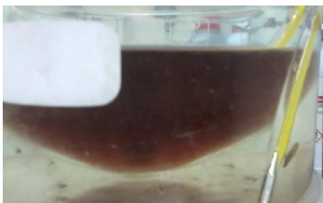
Σχήμα 4.36: Εμφάνιση αλάτων καλίου και αλλαγή του χρώματος κατά τη διαδικασία πολυμερισμού του αιθυλενοξειδίου.
