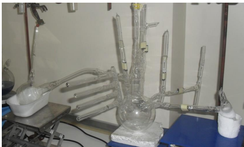
Σχήμα 4.10: Συσκευή πολυμερισμού για την σύνθεση του γραμμικού τρισυσταδικού τριπολυμερούς του τύπου PS- b -P2VP- b -PEO.
