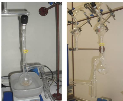
Σχήμα 4.4: Συσκευή που χρησιμοποιείται για τον καθαρισμό της 2-βινυλοπυριδίνης με \text{CaH}_2 . Αριστερά φαίνεται το πρώτο στάδιο καθαρισμού με \text{CaH}_2 , ενώ δεξιά φαίνεται η συσκευή που χρησιμοποιείται για τον καθαρισμό.
