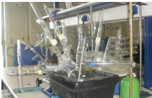
Σχήμα 4.12: Λουτρό ισοπροπανόλης/υγρού αζώτου σε θερμοκρασία -78^{\circ}\text{C} για τον πολυμερισμό του στυρενίου και της 2-βινυλοπυριδίνης προς σχηματισμό του ενεργού συμπολυμερούς του τύπου PS-b-P2VP\text{-}Li^{+} .
