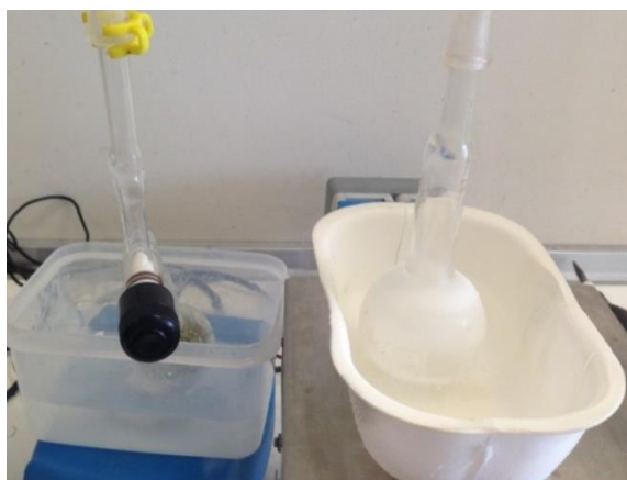
Σχήμα 4.19: Η διαδικασία απόσταξης του μονομερούς που δεν αντέδρασε στην γραμμική υψηλού κενού.
