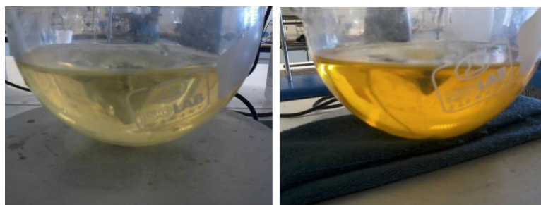
Σχήμα 4.35: Χρωματισμός διαλύματος μετά την εισαγωγή του διφαινύλου-μέθυλου-καλίου (DPMK).
