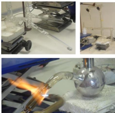
Σχήμα 4.5: Στις επάνω εικόνες απεικονίζεται μια συσκευή κατάλληλη για τον καθαρισμό της 2-βινυλοπυριδίνης. Κάτω φαίνεται ο τρόπος σχηματισμού του κατόπτρου Na.
