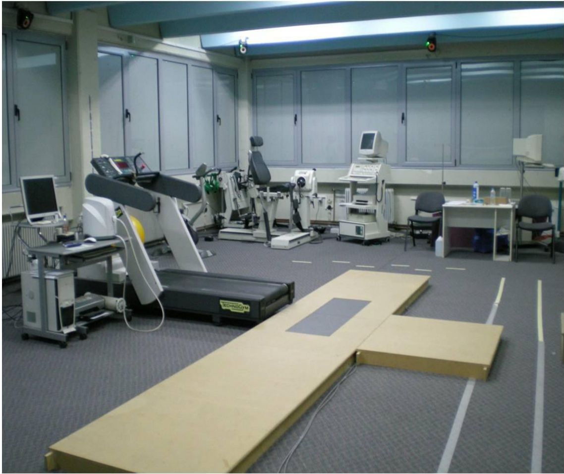
Εικόνα 4: Φωτογραφία της αίθουσας μελέτης της βάδισης όπου φαίνεται ο διάδρομος της εξέτασης, οι κάμερες και ο δυναμοδάπεδας.
