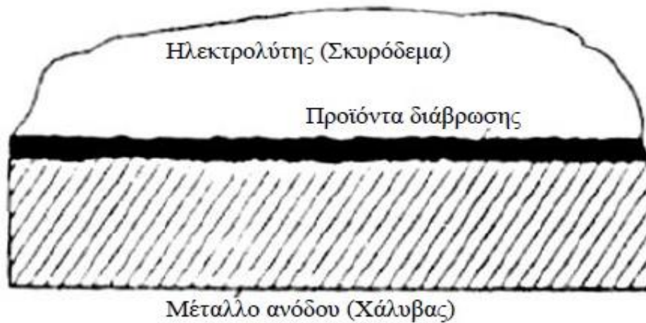
Σχήμα 2.7 Ομοιόμορφο στρώμα από το προϊόν της διάβρωσης που δημιουργείται κατά την ομοιόμορφη διάβρωση [17]
