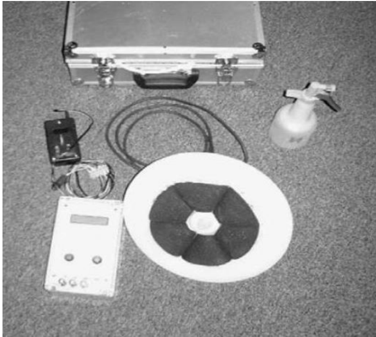
Σχήμα 3.5 Συσκευή μέτρησης του ρυθμού διάβρωσης που το βοηθητικό ηλεκτρόδιο είναι επίθεμα αφρού [14]
