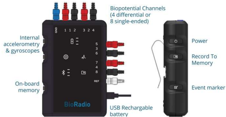
Σχήμα 3.12. Εξωτερικές υποδοχές και λειτουργίες της συσκευής BioRadio. Αναπαραγωγή από: (BioRadio Guide, glneurotech, 2017).
