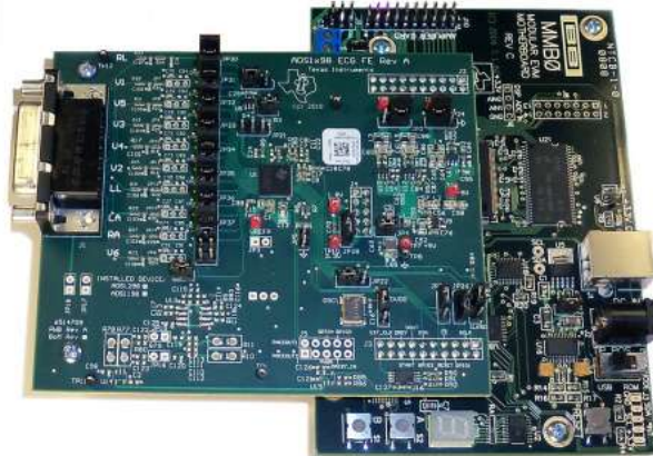
Σχήμα 3.9. Η αναπτυξιακή πλακέτα ADS1298RECG-FE και η μητρική πλακέτα MMB0. Αναπαραγωγή από: (Texas Instruments, 2016)
