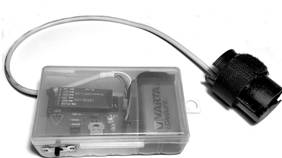
Σχήμα 4.13. Το σύστημα ασύρματης επικοινωνίας με Η/Υ, μέσω Bluetooth.
