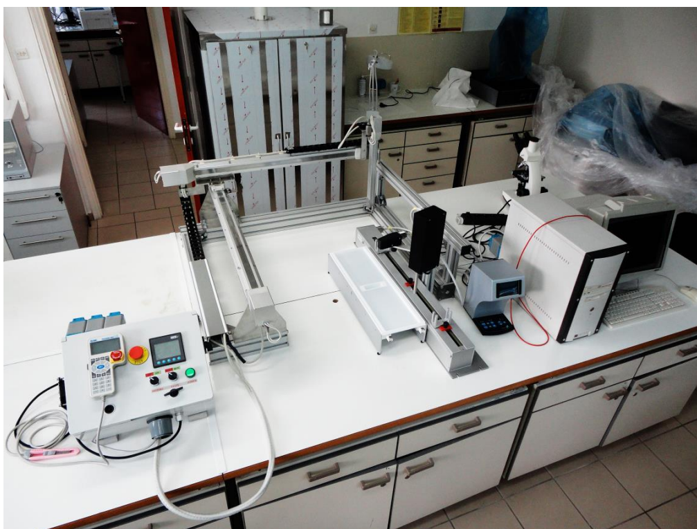
Σχήμα Γ.21. Συσκευή Langmuir-Blodgett και καρτεσιανό ρομποτικό σύστημα (Εργαστήριο Κεραμικών και Σύνθετων Υλικών, Τμήμα Μηχανικών Επιστήμης Υλικών, Πολυτεχνικής Σχολής, Πανεπιστημίου Ιωαννίνων).
