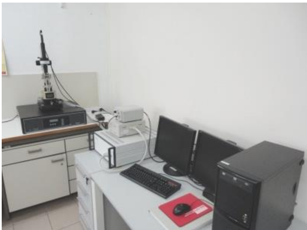
Σχήμα Γ.23. Μικροσκόπιο ατομικής δύναμης (AFM), Bruker Multimode Nanoscope 3D, του εργαστηρίου Κεραμικών και Σύνθετων Υλικών, του τμήματος Μηχανικών Επιστήμης Υλικών, της Πολυτεχνικής Σχολής, του Πανεπιστημίου Ιωαννίνων.
