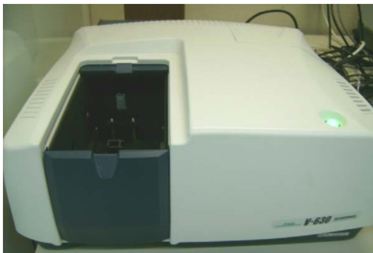
Εικόνα 4.5: Φασματοφωτόμετρο διπλής δέσμης (Jasco, V-630).
