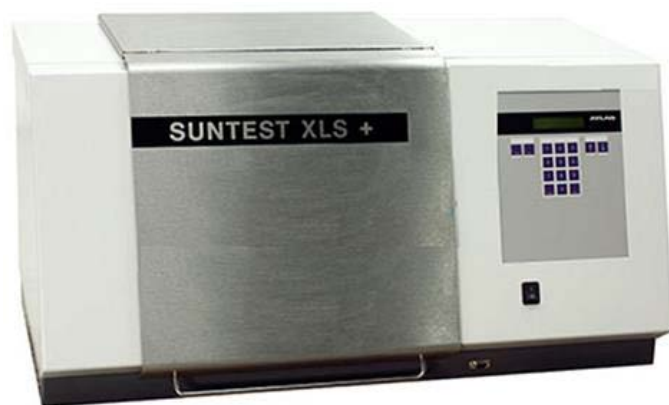
Εικόνα 4.3: Προσομοιωτής ηλιακής ακτινοβολίας SUNTEST XLS+ της εταιρείας Atlas.
