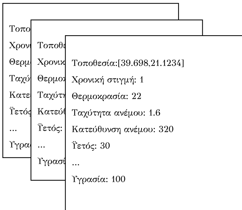
Σχήμα 3.7: Δομή προηγμένης αποθήκευσης μετεωρολογικών δεδομένων
