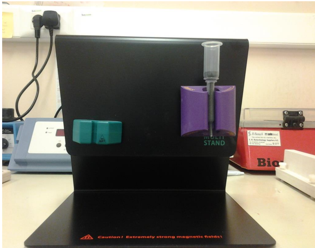
Εικόνα 9: Μαγνητικός διαχωριστής και βάσεις στήριξης στήλων.
