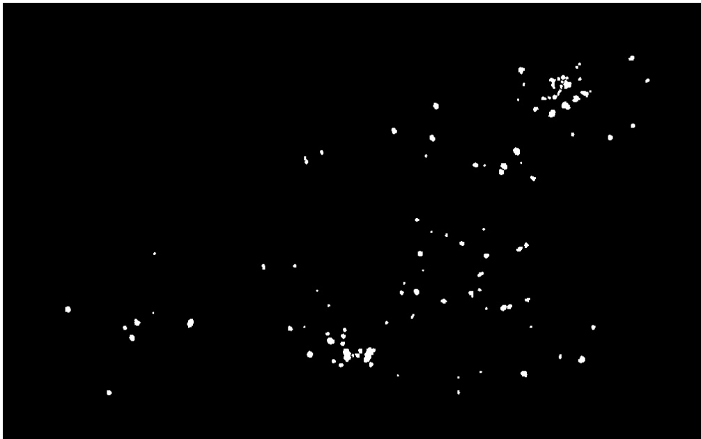
Εικόνα 4.10: Αφαίρεση της μη κυκλικής περιοχής συσσωμάτωσης και διατήρηση των κυκλικών δομών ενδιαφέροντος
