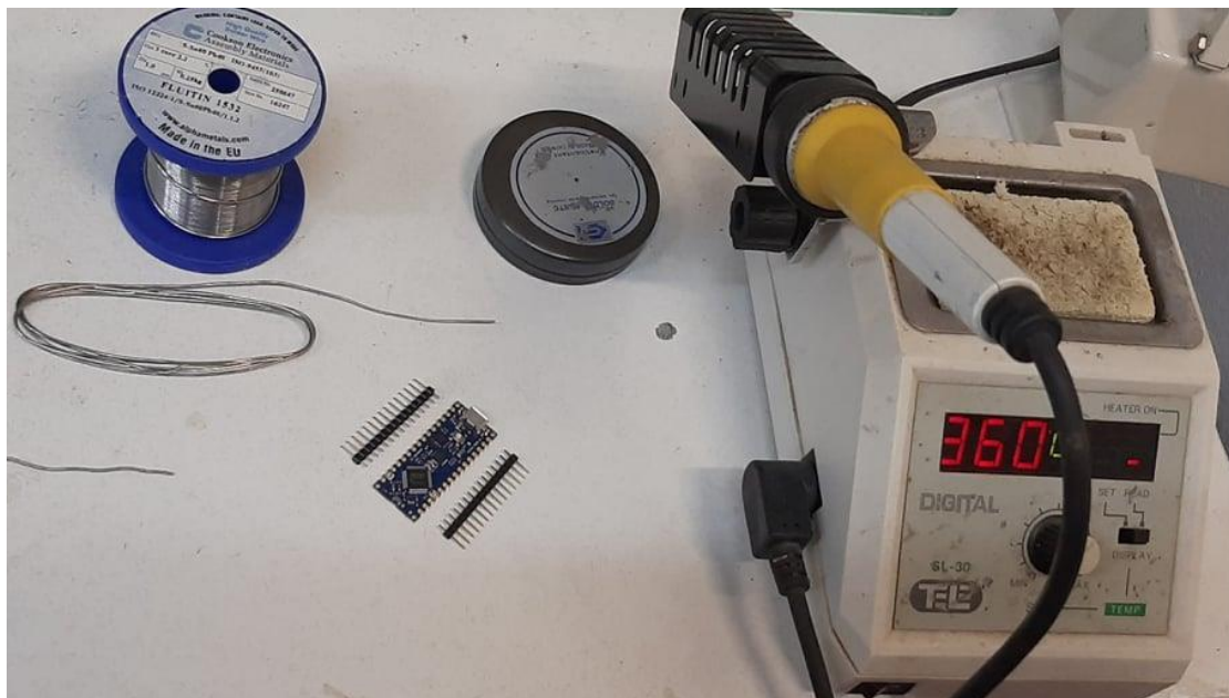
Εικόνα 3.4 Διαδικασία συγκόλλησης ακιδοσειρών επί των οπών υποδοχής της ηλεκτρονικής πλακέτας Arduino NANO EVERY σε πάγκο εργασίας
