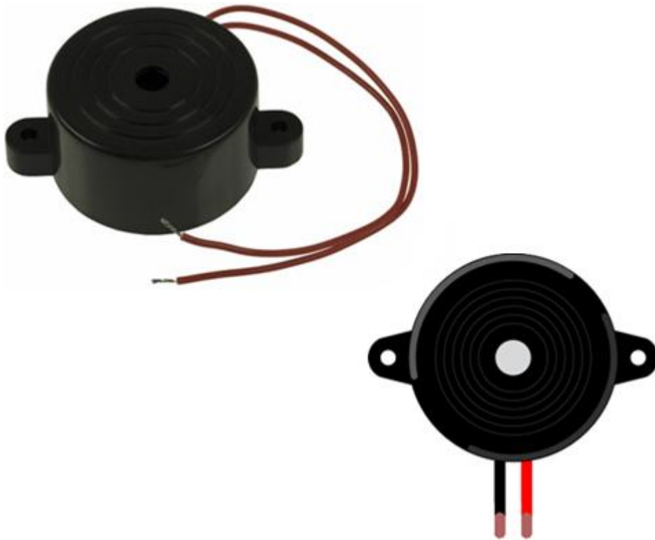
Εικόνα 2.68 Πιεζο-βομβητής ή αλλιώς πιεζο-ηχείο (άνω αριστερά) και απεικόνισή του σε περιβάλλον προσομοίωσης (κάτω δεξιά)
