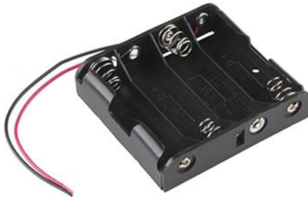
Εικόνα 2.59 Καλώδιο-συνδετήρας για τοποθέτηση τεσσάρων μπαταριών 4x1.5V AAA και σχηματισμό ενιαίας παροχής τάσης, είτε της τάξεως των 4,8V για επαναφορτιζόμενες μπαταρίες είτε της τάξεως των 6V για αλκαλικές μπαταρίες
