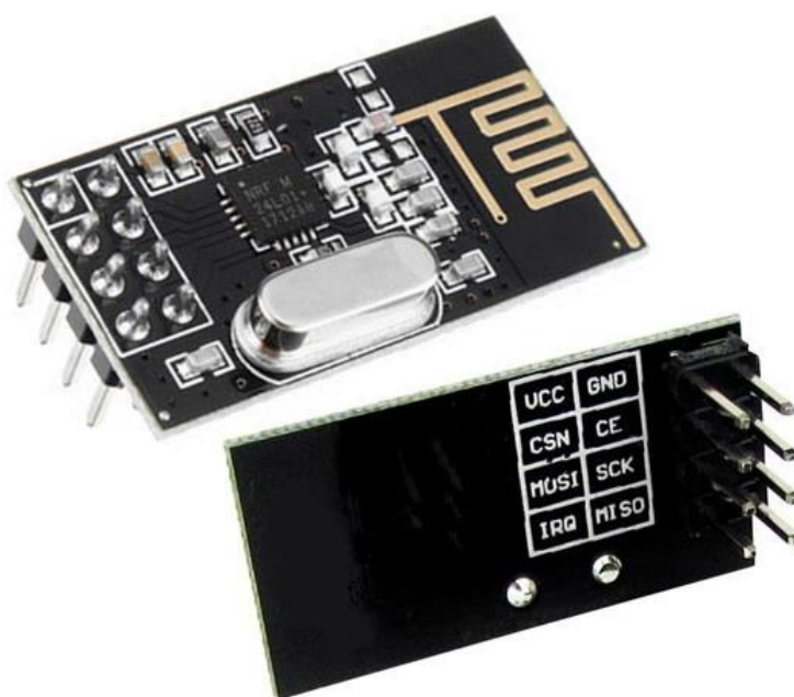
Εικόνα 2.19 Μοντέλο πομποδέκτη ραδιοσυχνότητων NRF24L01 με ενσωματωμένη κεραία
