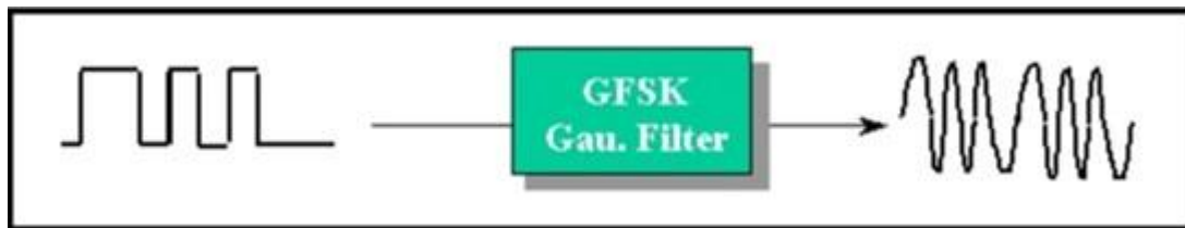
Εικόνα 2.23 Φίλτρο Gauss της διαμόρφωσης GFSK
