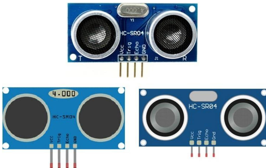
Εικόνα 2.64 Αισθητήρας υπερήχων μοντέλου HC-SR04 (άνω) και απεικονίσεις του σε περιβάλλοντα προσομοίωσης (κάτω)
