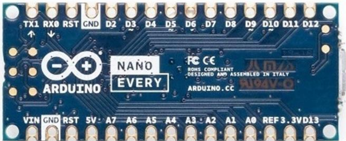
Εικόνα 2.14 Άνω και κάτω όψη της ηλεκτρονικής πλακέτας Arduino NANO EVERY
