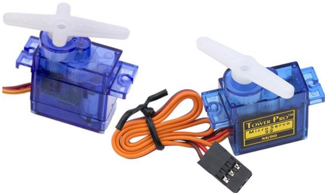
Εικόνα 2.35 Τυπικός περιστροφικός σερβοκινητήρας με διαφορετικούς μοχλούς επί του άξονά του
