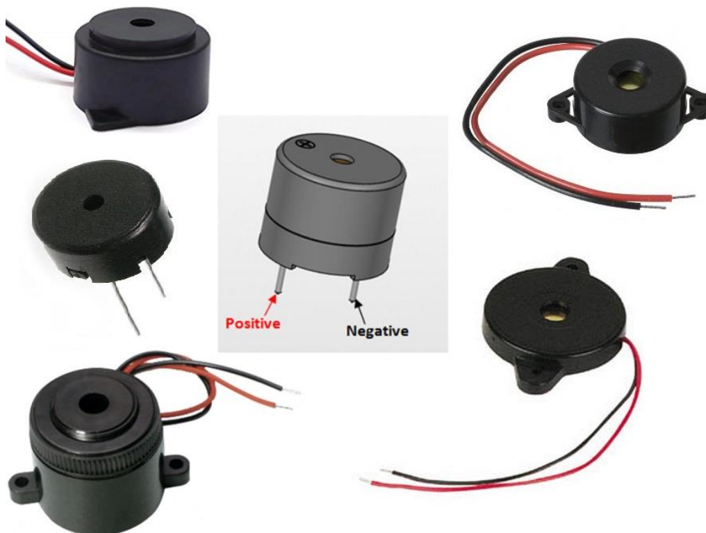
Εικόνα 2.69 Διάφορα είδη πιεζο-βομβητών και πολικότητα ακροδεκτών τους
