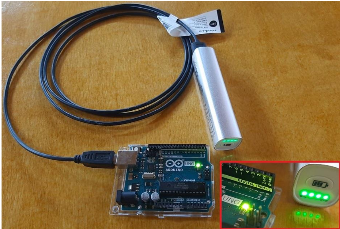
Εικόνα 3.79 Χρήση “power bank” ως εναλλακτική μέθοδος τροφοδοσίας του μικροελεγκτή Arduino UNO R3 ο οποίος με την σειρά του τροφοδοτεί ολόκληρο το Υποσύστημα Δέκτη ή αλλιώς Κύκλωμα RS του συστήματος ηλεκτρονικού ασύρματου ελεγκτή
