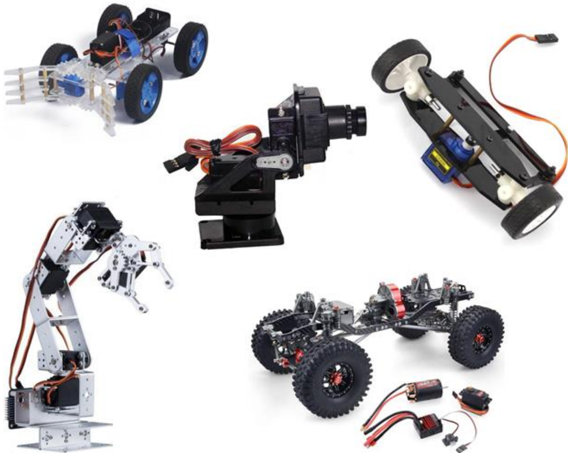
Εικόνα 2.34 Εφαρμογές περιστροφικών σερβοκινητήρων σε αυτοκινούμενα οχήματα, βιντεοκάμερες και ρομποτικούς βραχίονες
