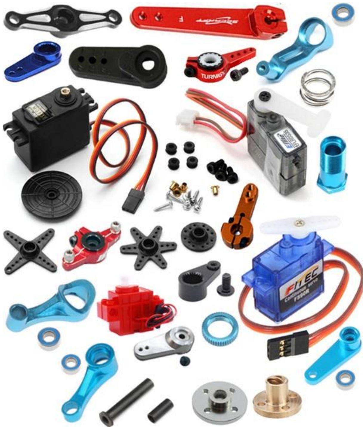
Εικόνα 2.38 Διάφορα μοντέλα αναλογικών & ψηφιακών περιστροφικών σεβροκινητήρων και είδη μοχλών τοποθέτησης επί του άξονά τους
