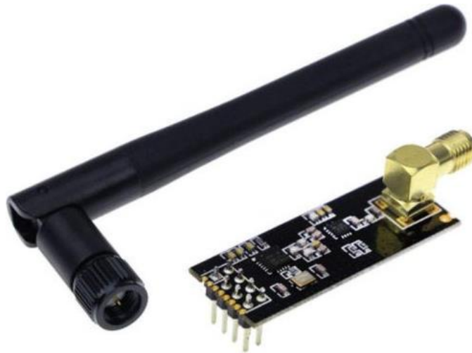
Εικόνα 2.31 Μοντέλο πομποδέκτη NRF24L01 με υποδοχή SMA για εξωτερική κεραία και RFX2401C chip (PA + LNA)
