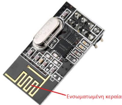
Εικόνα 2.29 Μοντέλο πομποδέκτη NRF24L01 με ενσωματωμένη κεραία
