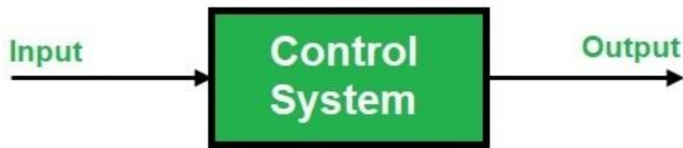
Εικόνα 1.2 Σχηματικό διάγραμμα ενός απλού συστήματος ελέγχου – Σύστημα απόκρισης 1 εισόδου με 1 έξοδο
