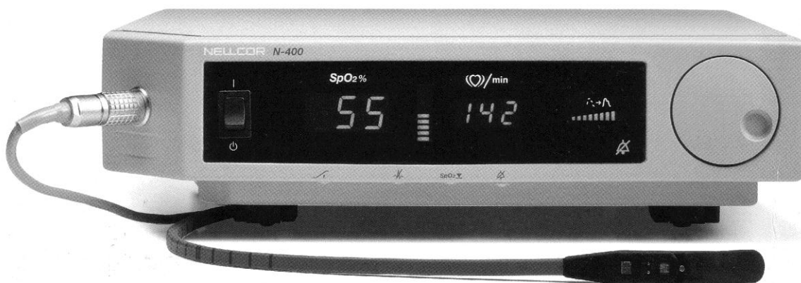
Εικόνα 14. Η βασική συσκευή του εμβρυϊκού παλμικού οξύμετρου (από Nellcor Puritan Bennet, N-400 Foetal Oxygen Saturation Monitoring System: Technical Issues, 1997, p1).
