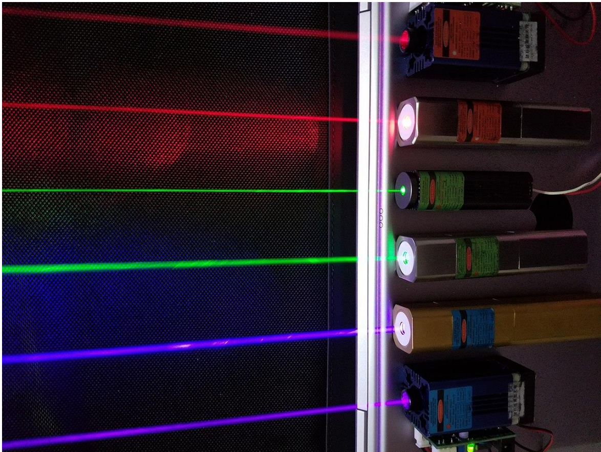
Εικ. 4. Παραγωγή έγχρωμων μονοχρωματικών ακτίνων φως οι οποίες παράγονται από κατάλληλες λυχνίες.
