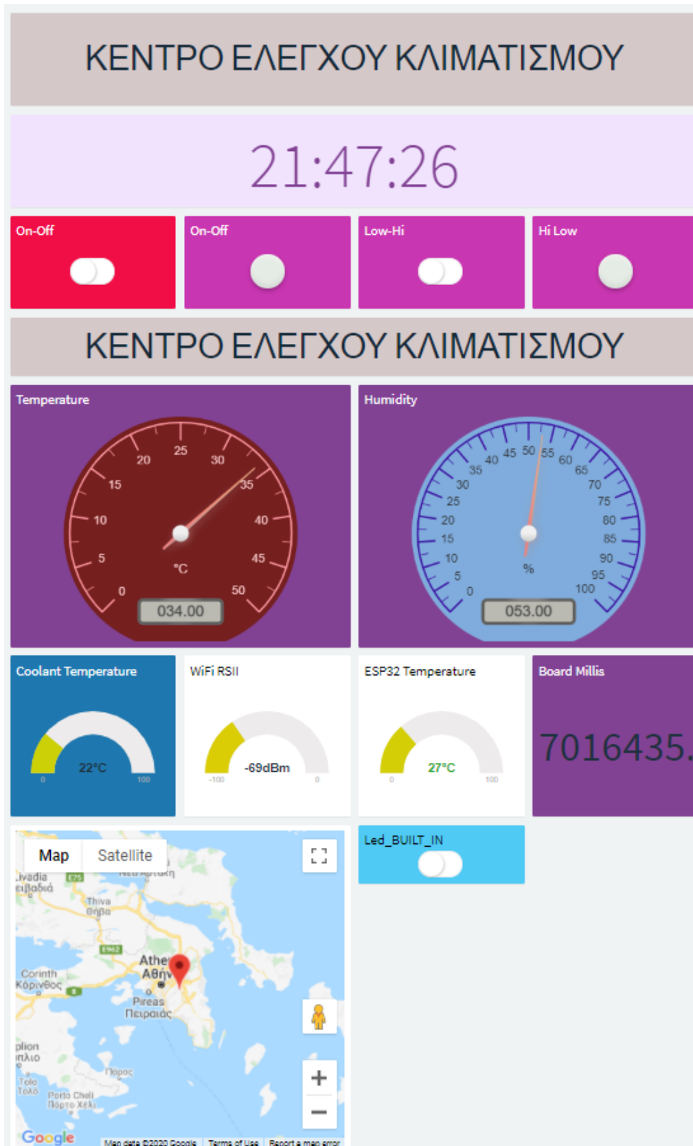
Εικόνα Α.2.18 Το dashboard για το έργο που δημιουργήθηκε στην πλατφόρμας Thingier.io
