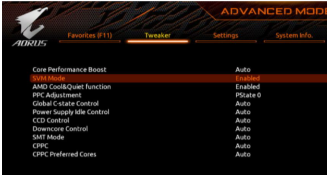
Εικόνα 4.8 Η επιλογή SVM Mode έπρεπε να ενεργοποιηθεί για την υποστήριξη του hardware virtualization
