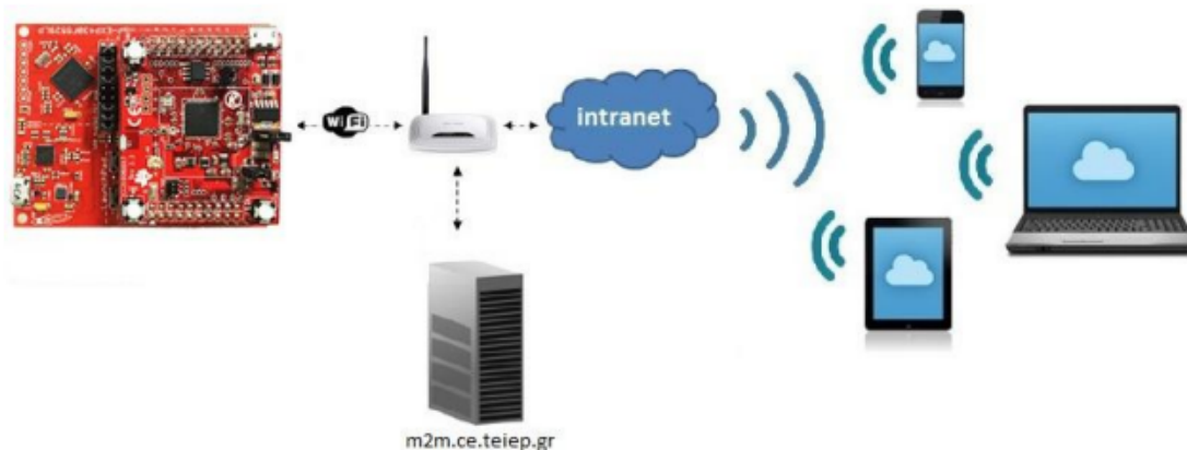
Εικόνα 4.24 Τα βασικά μέρη του έξυπνου συστήματος περιβαντολλογικού ελέγχου
