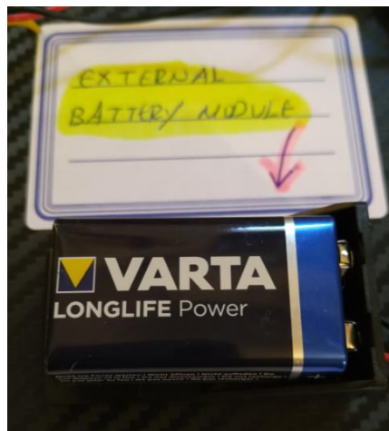
Εικόνα 52: Προαιρετική μονάδα εξωτερικής παροχής ενέργειας μέσω μπαταρίας 9V
