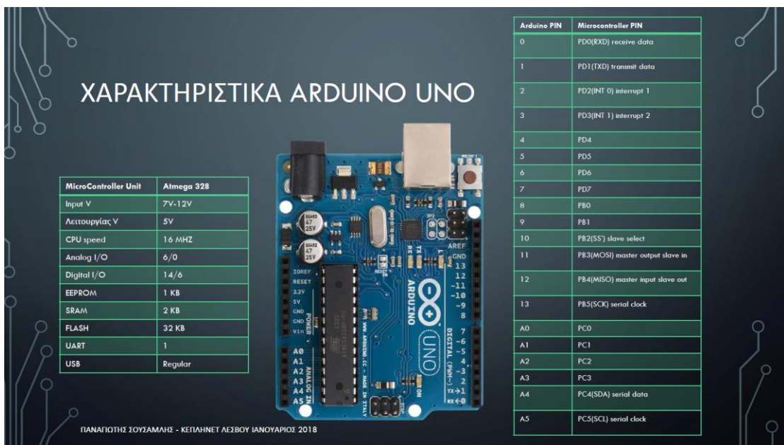
Εικόνα 24: Χαρακτηριστικά ARDUINO UNO (Πηγή: [8])
