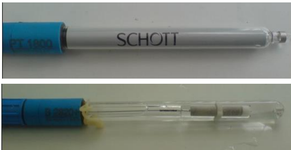
Εικόνα II.6.2. Πάνω εικόνα: Βοηθητικό ηλεκτρόδιο (AE), πλατίνας και κάτω εικόνα: ηλεκτρόδιο αναφοράς (RE) χλωριούχου αργύρου (Ag/AgCl)
