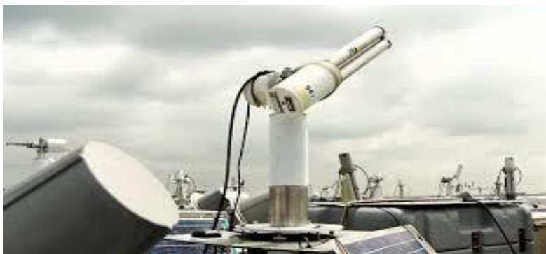
Σχήμα 2.3. Φασματόμετρο CIMEL των σταθμών AERONET
