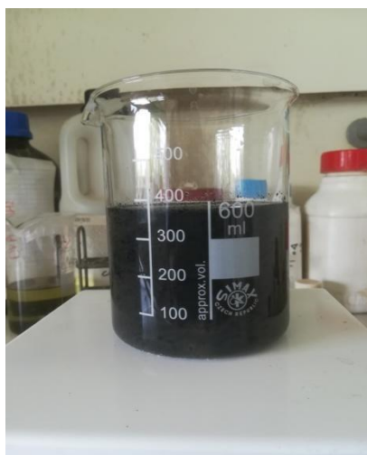
Εικόνα 12: Ανάδευση μείγματος ενεργού άνθρακα με HCl σε ποτήρι ζέσεως
