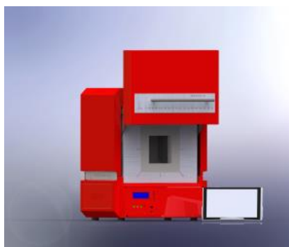
Εικόνα 11: Ο φούρνος που χρησιμοποιήθηκε στην πυρόλυση
