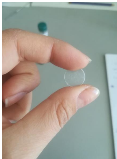
Εικόνα 14: Συμπιεσμένο δίσκιο με KBr και ενεργό άνθρακα.
