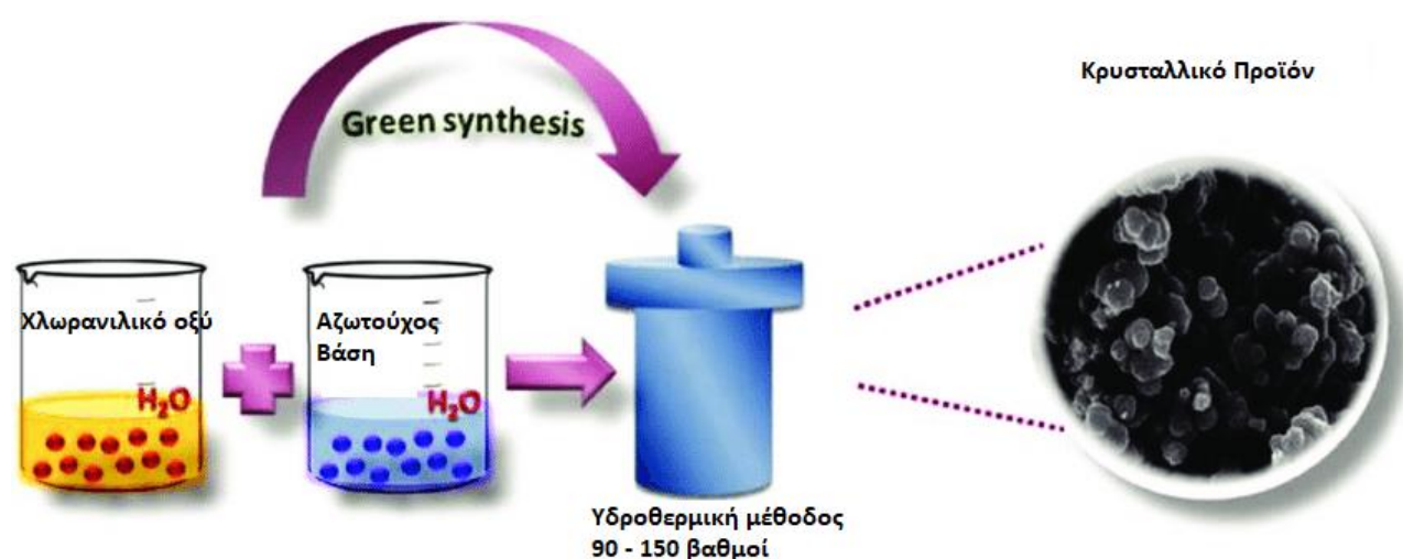
Σχήμα 21: Η Υδροθερμική Μέθοδος: Τα αντιδρώντα προστίθενται σε αυτόκλειστο περιέκτη και τοποθετούνται σε ειδικό πυριαντήριο σε υψηλή για το διαλύτη θερμοκρασία. Η διαφορά της υδροθερμικής με τη διαλυτοθερμική μέθοδο εγκείται στο χρησιμοποιούμενο διαλύτη και στο εύρος θερμοκρασιών
