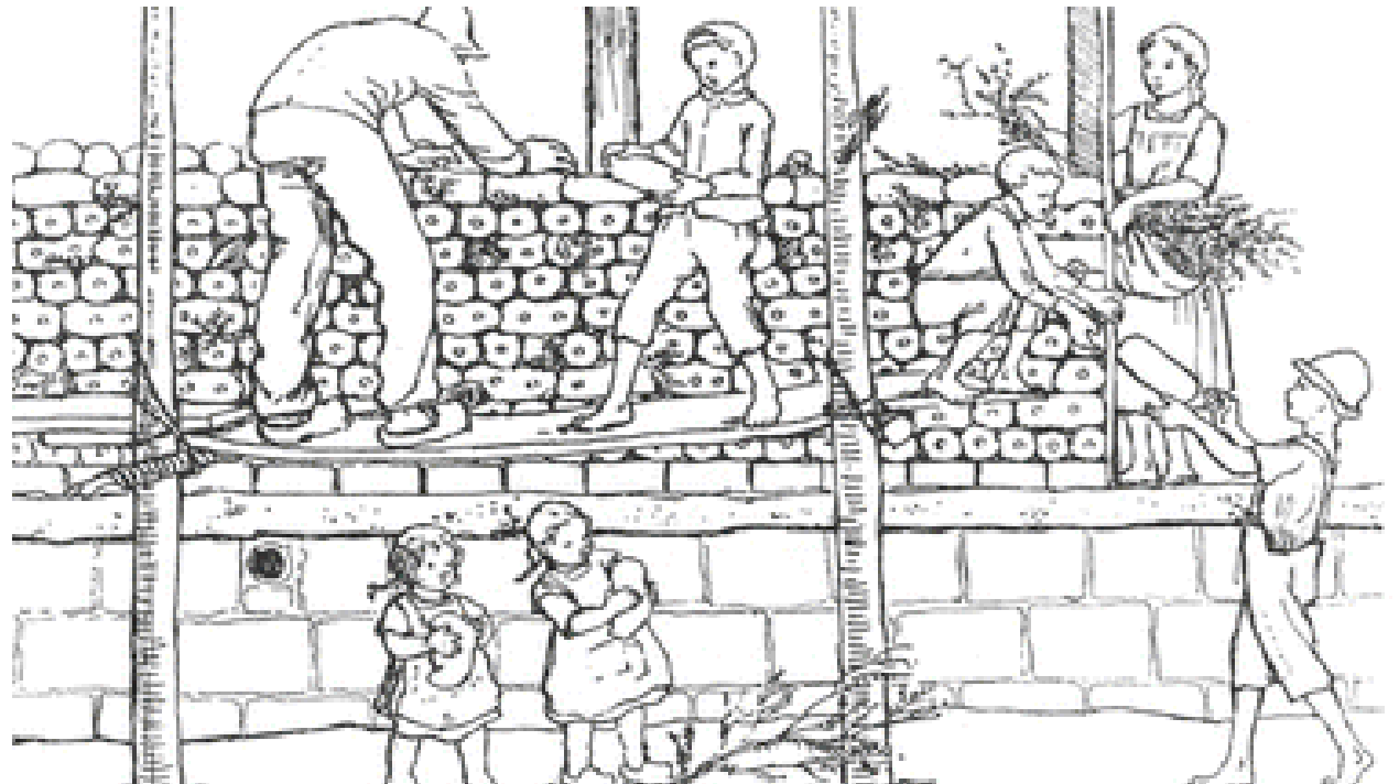
Εικ.91: Απεικόνιση τρόπου κατασκευής τοιχοποιίας με την τεχνική Duenner.
