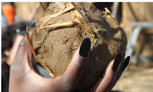
Εικ.114 : Δομική μονάδα σε σχήμα σβόλου Για την κατασκευή κυκλικών χώρων έχει πλαστεί σε σχήμα σφαίρας(εικ.115),το οποίο στοιβάζεται και πιέζεται στην τοιχοποιία. Στην συνέχεια σοβατίζεται, εξομαλύνεται και γυαλίζεται ο τοίχος, εσωτερικά και εξωτερικά.
