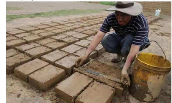
Εικ.98: Λείανση του χυτού υλικού στο καλούπι
