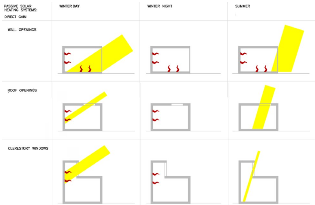
Εικόνα 2.5: Παραδείγματα συστημάτων άμεσου ηλιακού κέρδους κατά την ημέρα και τη νύχτα του χειμώνα και κατά το καλοκαίρι.
