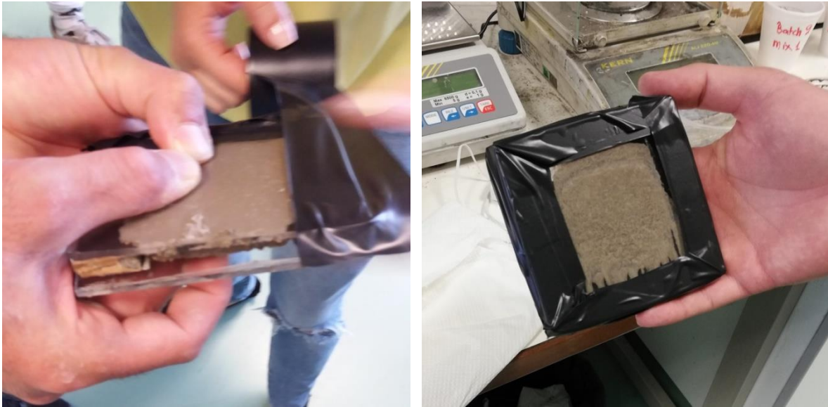
Εικόνα 24: Στεγάνωση του δοκιμίου με χρήση μονωτικής ταινίας
