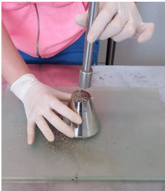
Εικόνα 20: Συμπύκνωση της άμμου κατά τη δοκιμή υδατοαπορροφητικότητας
