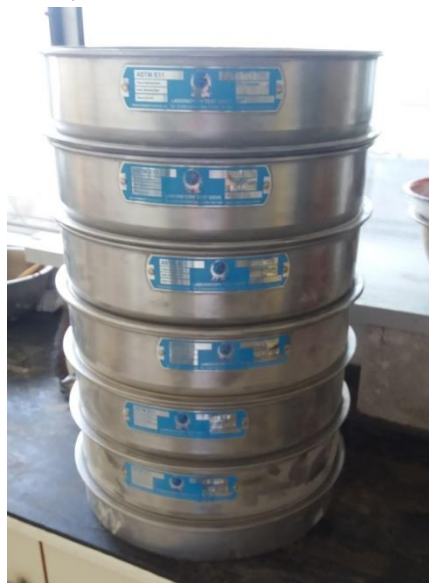
Εικόνα 15: Κόσκινα αμερικανικής σειράς (βάσει του ASTM E11)
