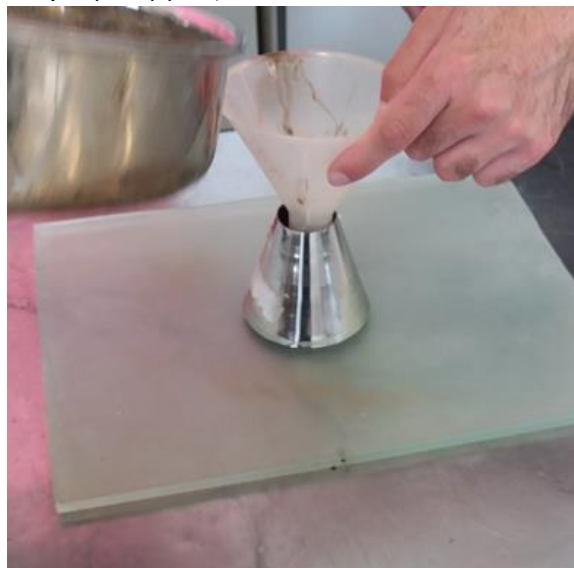
Εικόνα 19: Πλήρωση μεταλλικού κώνου με άμμο κατά την δοκιμή υδατοαπορροφητικότητας
