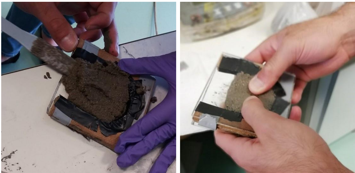
Εικόνα 23: Τοποθέτηση μίγματος κονιάματος στο καλούπι : α) διάστρωση με χρήση σπάτουλας, και β) άσκηση πίεσης για απομάκρυνση φυσαλίδων αέρα
