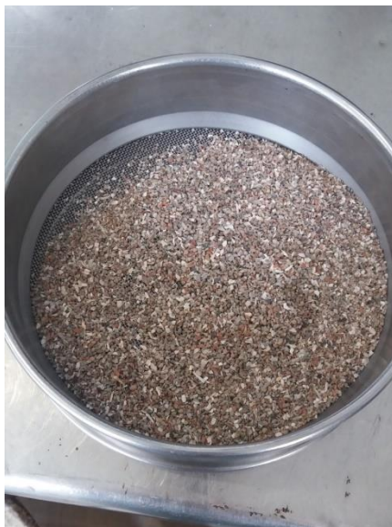
Εικόνα 16: Αδρανή διερχόμενα από το κόσκινο Νο16 και συγκρατούμενα στο κόσκινο Νο20
