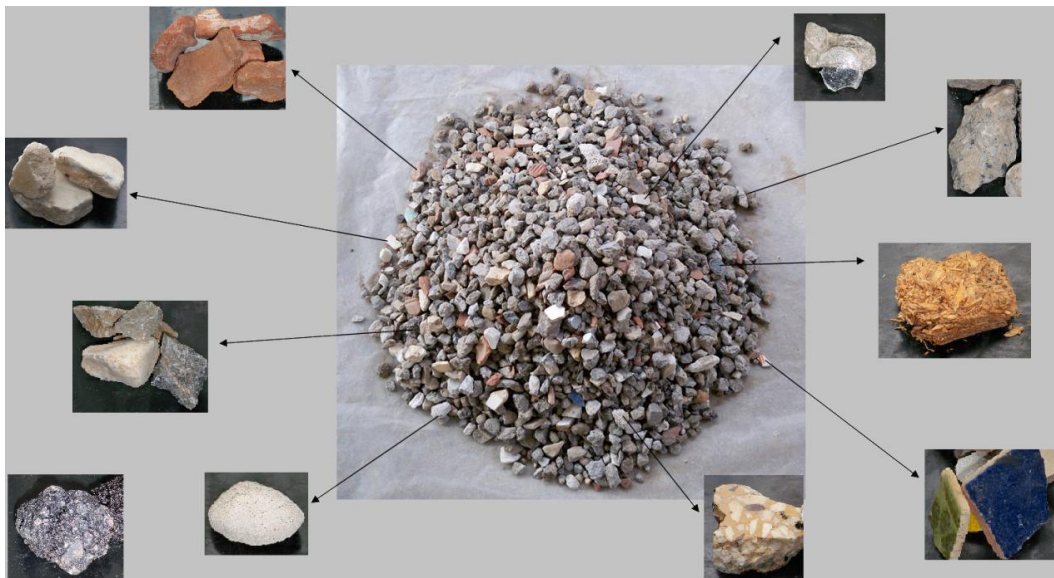
Εικόνα 14: Ανακυκλωμένα αδρανή και περιεχόμενα σε αυτά υλικά
