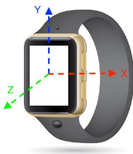
Εικόνα 4-3: Καταγραφή σημάτων από τους αισθητήρες της συσκευής smartwatch στον τρισδιάστατο χώρο
