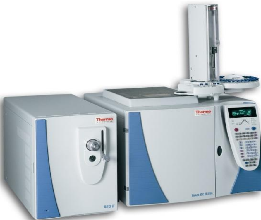
Σχήμα 2.12 Ενόργανη διάταξη αέριου χρωματογράφου συζευγμένου με ανιχνευτή μάζας
