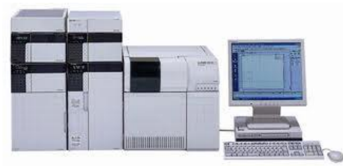
Σχήμα 2.14: Ενόργανη διάταξη υγρού χρωματογράφου συζευγμένου με ανιχνευτή μάζας
