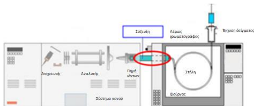
Σχήμα 5.9: Σχηματική διάταξη αέριου χρωματογράφου (Πηγή: www.chromacademy )
