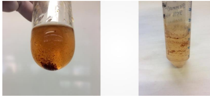
Σχήμα 8.19: Σχηματισμός μικροσταγόνων σε δοκιμαστικό σωλήνα και σε σωλήνα falcon
