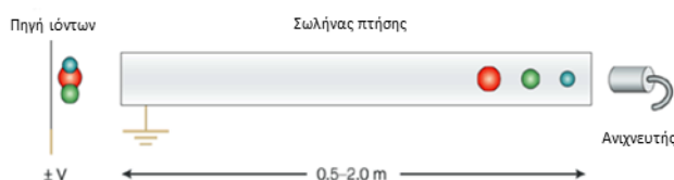
Σχήμα 5.18: Αρχή λειτουργίας ανιχνευτή χρόνου πτήσης (TOF) (Stauffer et al., 2008)
