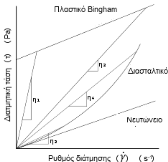
Σχ. 2.23. Γραφικός προσδιορισμός φαινομενικού ιξώδους για δεδομένο ρυθμό διάτμησης (Steffe, 1996).
