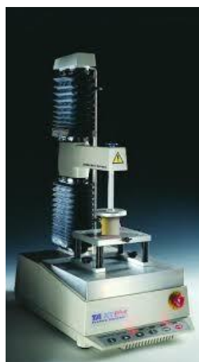
Σχ. 4.5. Αναλυτής υφής TA.XTplus Texture Analyser με διάταξη συμπίεσης ( \varnothing = 100 mm).
