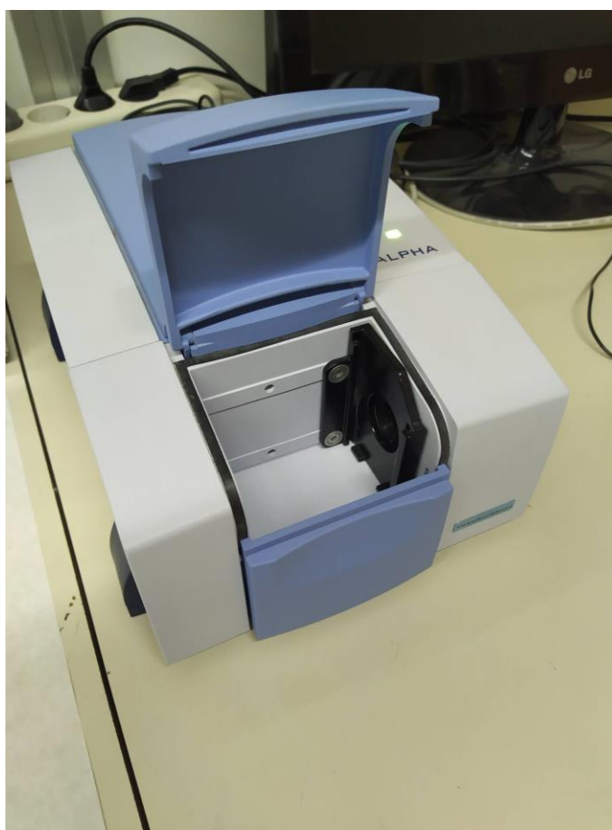
Σχήμα 6.3. Ο φασματογράφος υπερόθρου (FTIR). Μοντέλο Alpha της εταιρείας Bruker, με προσαρμοσμένο το εξάρτημα ολικής ανάκλασης (ATR) ο οποίος χρησιμοποιήθηκε για τη λήψη φασμάτων υπερόθρου των δειγμάτων [5].
