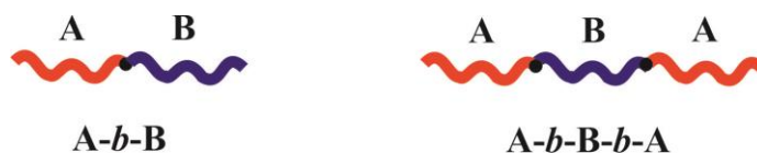
Σχήμα 1: Σχηματική αναπαράσταση δισυσταδικού (A-b-B) και τρισυσταδικού (A-b-B-b-A) συμπολυμερούς αντίστοιχα.
