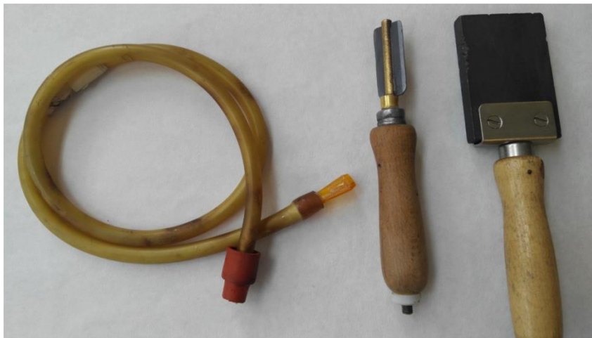
Σχήμα 6.3: Εξαρτήματα που χρησιμοποιούνται στην επιστημονική υαλοργία, από αριστερά προς τα δεξιά: Λάστιχο με μέσο έμφυσης για την πραγματοποίηση κολλημάτων μεταξύ δύο διαφορετικών γυάλινων τμημάτων, μέσο εγχάραξης γυάλινων επιφανειών ανάλογα με τις ανάγκες, κατάλληλη σπάτουλα για εξομάλυνση γυάλινων επιφανειών.
