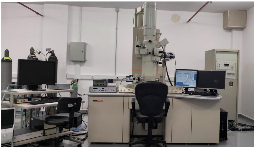
Σχήμα 5.5: Διάταξη οργανολογίας ηλεκτρονικής μικροσκοπίας διέλευσης τύπου JEOL JEM - 2100HR.
