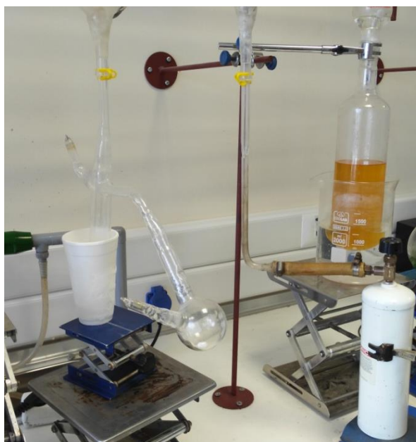
Σχήμα 6.8: Συσκευή καθαρισμού του 1,3-βουταδιενίου και η οβίδα που το περιέχει αρχικά.
