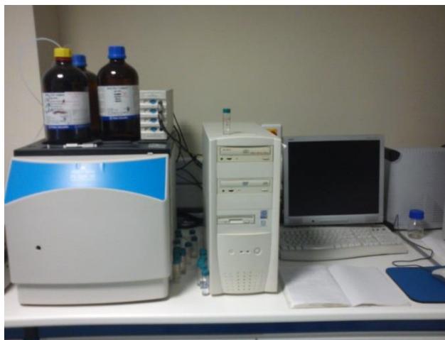
Σχήμα 5.1: Διάταξη οργανολογίας χρωματογράφου αποκλεισμού μεγεθών PL-50.
