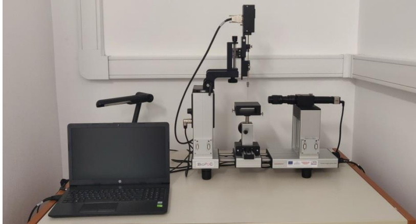
Σχήμα 5.7: Διάταξη οργανολογίας γωνιομέτρου DataPhysics OCA 25.
