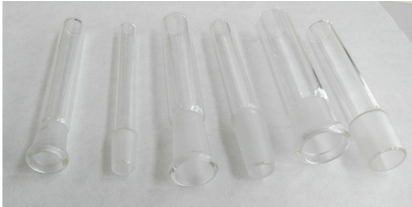
Σχήμα 6.2: Διαφόρων τύπων και διατομών εσμυρίσματα (αρσενικά και θηλυκά).
