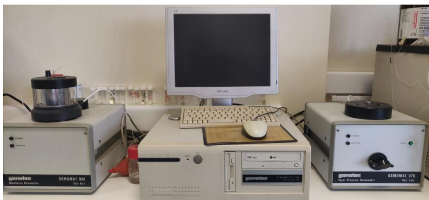
Σχήμα 5.3: Οργανολογία οσμωμετρίας, μεμβράνης Gonotec Osmomat 090 (αριστερά) και τάσης αμίων Osmomat 070 (δεξιά).
