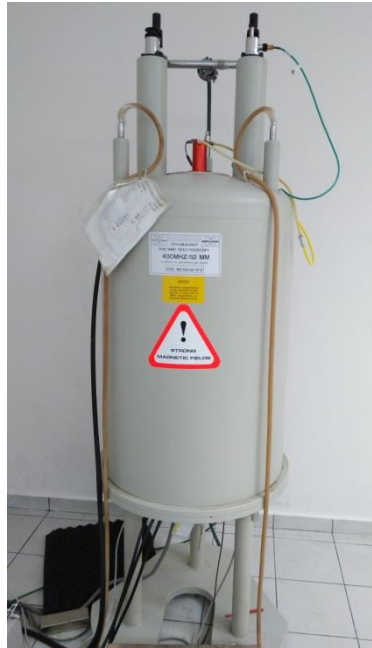
Σχήμα 5.2: Φασματογράφος Bruker AV-400, όπου έγιναν οι μετρήσεις των δειγμάτων με φασματοσκοπία ^1\text{H-NMR} .
