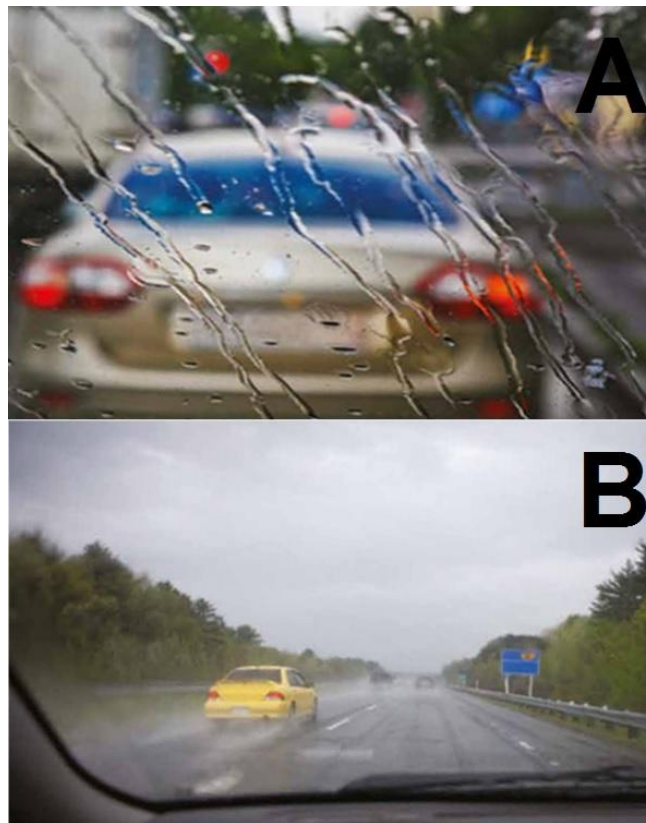
Σχήμα 1.1.2 Πριν (A) και μετά (B) την τοποθέτηση υδρόφοβου φιλμ στο τζάμι αυτοκινήτου.
