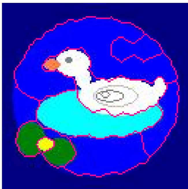
Σχήμα 6.3.13 White Duck: Κατάτμηση χρώματος (C)
