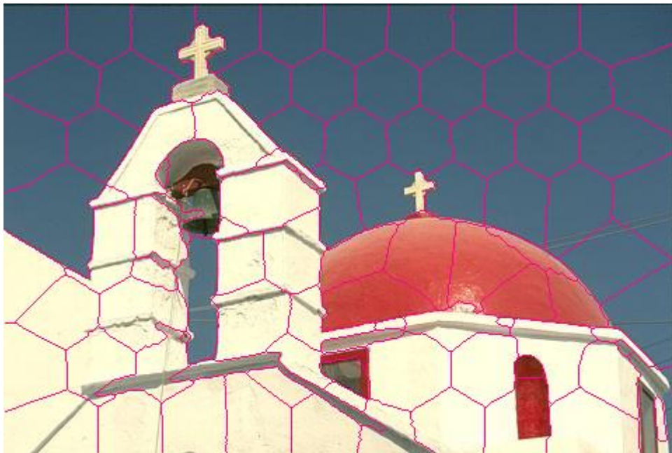
Σχήμα 6.2.1 Παράδειγμα κατάτμησης SLIC με 100 superpixels
