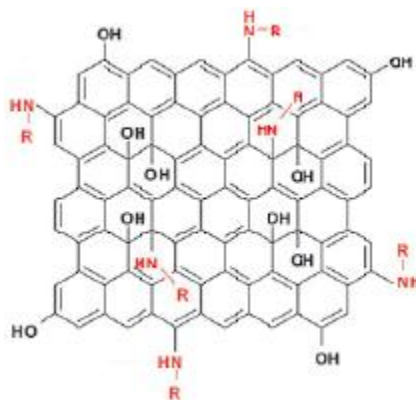
Εικ. 2.1. Δομή οξειδίου του γραφενίου (GO) τροποποιημένου με αλκυλαμίνες, όπου επιδεικνύει το φαινόμενο του φθορισμού.
