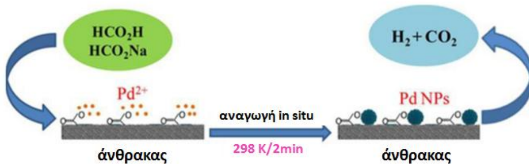
Σχήμα 2.8: Σχηματική αναπαράσταση του σχηματισμού μεταλλικών νανοσωματιδίων Pd σε επιφάνεια άνθρακα [116].
