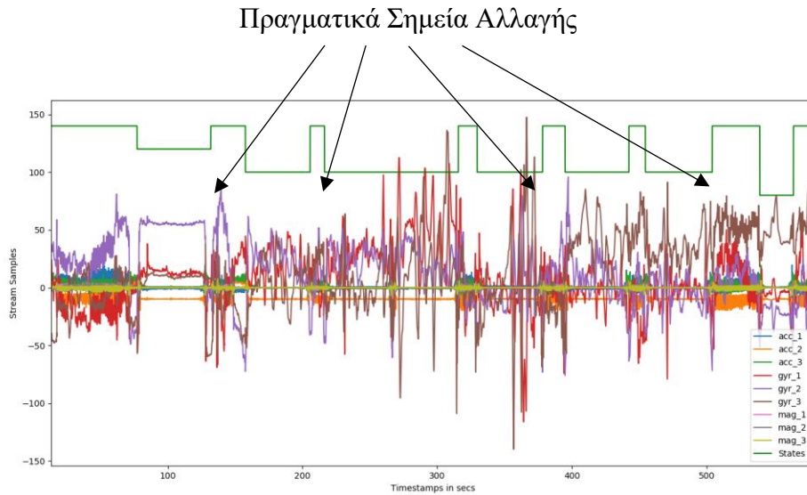
Σχήμα 1.1 Δείγμα σημάτων 3 αισθητήρων που καταγράφουν ανθρώπινες δραστηριότητες χαμηλού επιπέδου.
