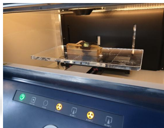
Σχήμα 13. Το φασματοσκόπιο M4 Tornado. Διαθέτει κινητή τράπεζα με μετρήσιμη επιφάνεια 200 mm x 160 mm, μέγιστο ύψος δείγματος 120 mm, μέγιστο βάρος δείγματος 7 kg και ταχύτητα σάρωσης έως 100 mm / s και με ελάχιστο μέγεθος βήματος 4 μm.[11]
