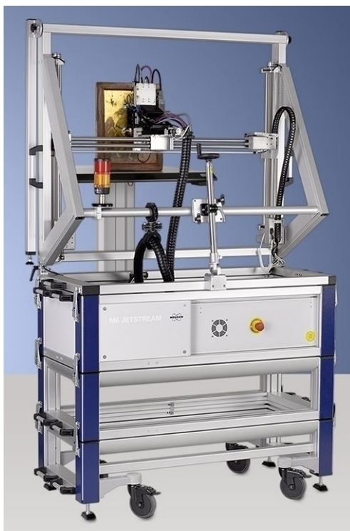
Σχήμα 18. Φασματοσκόπιο Macro-XRF (M6-Jetstream) της εταιρίας Bruker. Το συγκεκριμένο φασματοσκόπιο έχει σχεδιαστεί για τη μη καταστρεπτική στοιχειακή ανάλυση μεγάλων δειγμάτων. Η κινητικότητα του οργάνου επιτρέπει την τοποθέτησή του στο χώρο του αντικειμένου ενδιαφέροντος, είτε σε γκαλερί, μουσείο κτλπ. Οι μέγιστες διαστάσεις σάρωσης έχουν είναι 800 mm x 600 mm με ελάχιστο βήμα σάρωσης 100 μm και ταχύτητες μέχρι 100 mm / s.[12,13]
