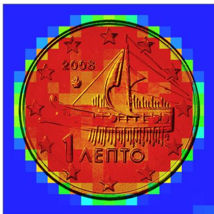
Σχήμα 109. Αριστερά) Η χαρτογραφημένη περιοχή όπου έχει ανιχνευθεί χαλκός στο νόμισμα του ενός λεπτού (εθνική όψη). Οι μετρήσεις δεξιά του διαγράμματος αντιπροσωπεύουν το συνολικό αριθμό φωτονίων που έχουν ανιχνευθεί για το χαλκό. Δεξιά) Η χαρτογραφημένη περιοχή όπου έχει ανιχνευθεί σίδηρος.
