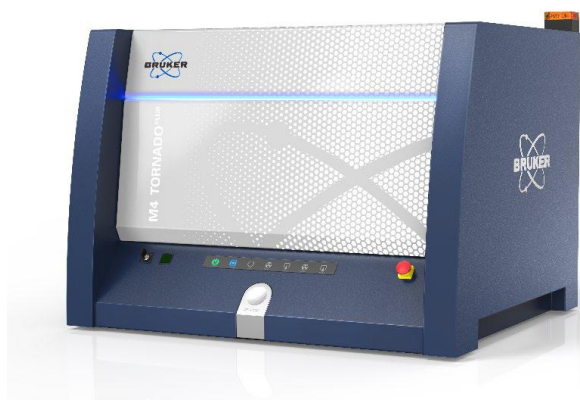
Σχήμα 13. Το φασματοσκόπιο M4 Tornado. Διαθέτει κινητή τράπεζα με μετρήσιμη επιφάνεια 200 mm x 160 mm, μέγιστο ύψος δείγματος 120 mm, μέγιστο βάρος δείγματος 7 kg και ταχύτητα σάρωσης έως 100 mm / s και με ελάχιστο μέγεθος βήματος 4 μm.[11]
