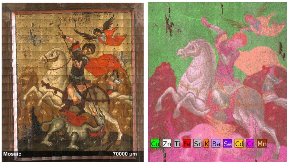
Σχήμα 19. Επάνω αριστερά) Σλαβική αγιογραφία. Επάνω δεξιά) Στοιχειακή χαρτογράφηση που πραγματοποιήθηκε με το M6 Jetstream, και αποκαλύπτοντας τα στοιχεία Cu, Zn, Ti, Fe, Sr, K, Ba, Se, Cd, Cr και Mn..[13]
