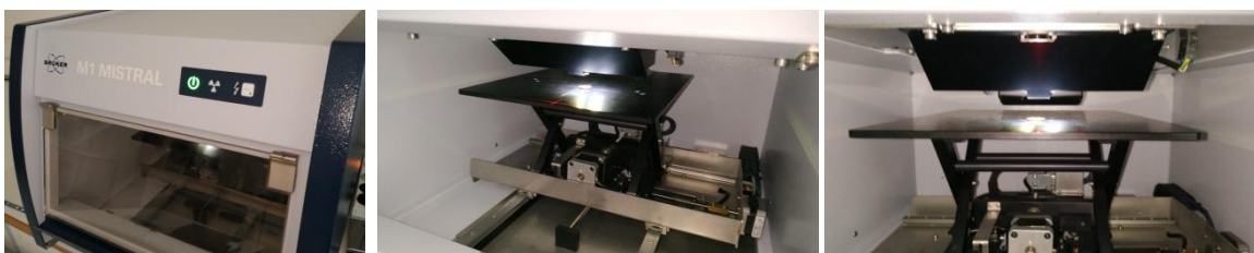
Σχήμα 27. Το φασματοσκόπιο M1 Mistal του εργαστηρίου ακτίνων X του T.M.E.Y. Αριστερά) Το όργανο με κλειστό παράθυρο ασφαλείας σε λειτουργία. Μέση-Δεξιά) Το νόμισμα του 1 cent επί του δειγματοφορέα, ο οποίος αποτελείται από κινητή τράπεζα (x-y-z)
