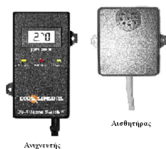
Εικόνα 2.2.3.2.1. συσκευή ανίχνευσης αερίου όζοντος OS-4.
