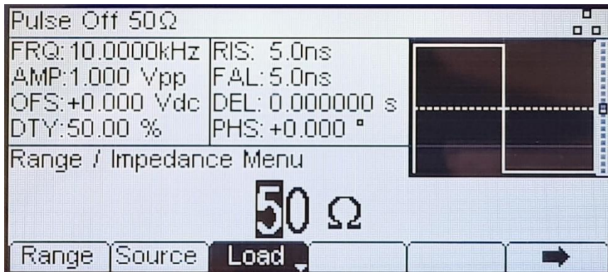
Εικόνα Α.1 Η επιλογή ρύθμισης αντίστασης εξόδου της γεννήτριας.
