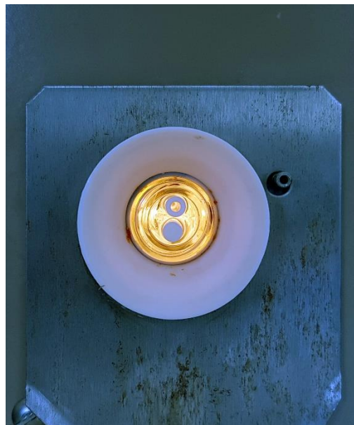
Εικόνα Α.14 Η πλευρικές οπές πλήρωσης και αφαίρεσης του δείγματος. Δεξιά αυτών βρίσκεται η έξοδος αέρα για τον καθαρισμό του εσωτερικού σωλήνα μέτρησης.
