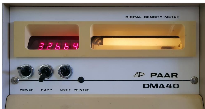
Εικόνα Α.13 Η όψη της συσκευής μέτρησης πυκνότητας. Διακρίνονται η οθόνη μέτρησης, ο φωτιζόμενος θάλαμος μέτρησης του δείγματος καθώς και διαθέσιμοι διακόπτες.
