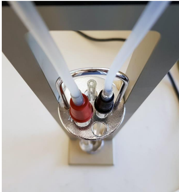
Εικόνα Α.9 Σύνδεση του σωλήνα Ubbelohde με το αυτόματο σύστημα μέτρησης ιζώδους, η πλήρωση του δείγματος γίνεται από την σπή με τον αριθμό 4.
