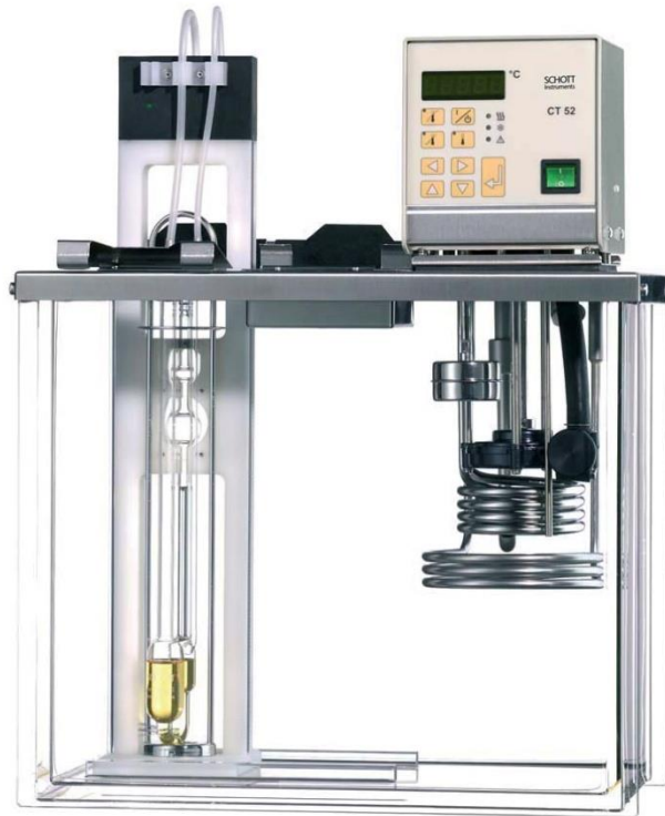
Εικόνα Α.11 Το σύστημα μέτρησης ιξώδους. Διακρίνονται η δεξαμενή υγρού θερμοστάτισης, ο θερμοστάτης ο οποίος είναι υπεύθυνος για τη θέρμανση και ψύξη (με σύνδεση σε εξωτερικό σύστημα ψύξης) του λουτρού και η βάση μέτρησης του ιξώδους. Η βάση συνδέεται με το τερματικό μέτρησης για την καταγραφή του χρόνου ροής.
