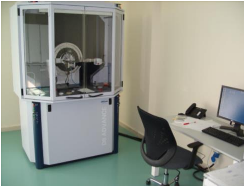
Εικόνα 5.19: Περιθλασόμετρο ακτίνων –Χ Τμήματος Επιστήμης Υλικών Πανεπιστημίου Ιωαννίνων.
