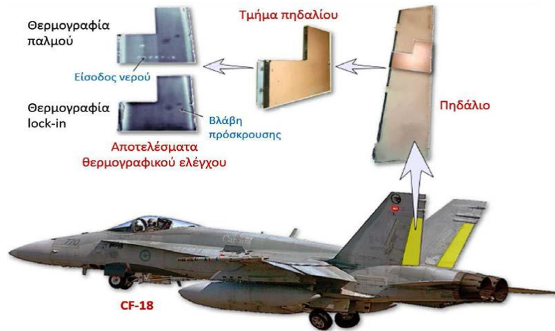
Εικόνα 7 Θερμογραφικός έλεγχος του πηδαλίου του μαχητικού αεροσκάφους [45].
