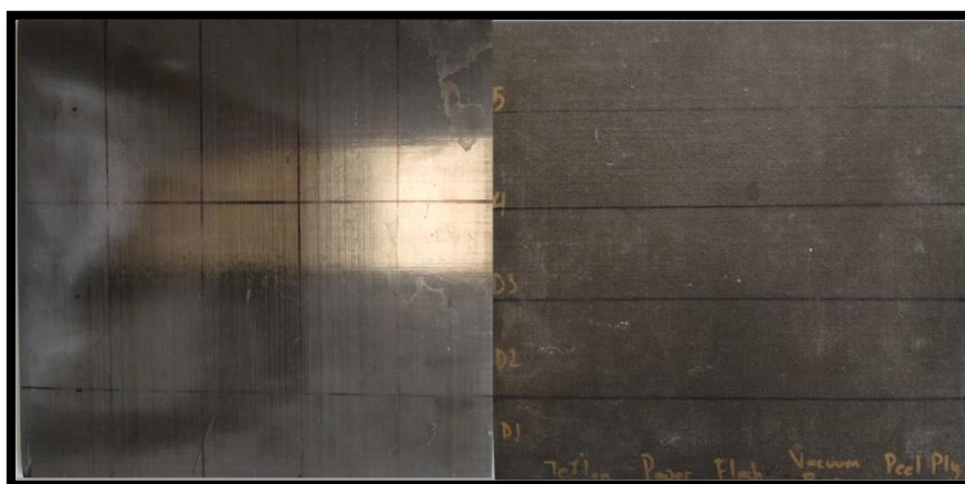
Εικόνα 23 Πρότυπη πλάκα CFRP με τεχνητά ελαττώματα.
