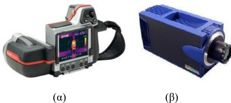
Εικόνα 6 Υπέρυθρες θερμικές κάμερες 52: (α) LWIR θερμική κάμερα FLIR ThermaCAM T360, με FPA 320x240 pixels, φασματική απόκριση 7.5–13 \mu\text{m} . (β) MWIR θερμική κάμερα CEDIP/JADE με ανιχνευτή InSb και FPA 320x240 pixels, φασματική απόκριση 3.6–5.0 \mu\text{m} .
