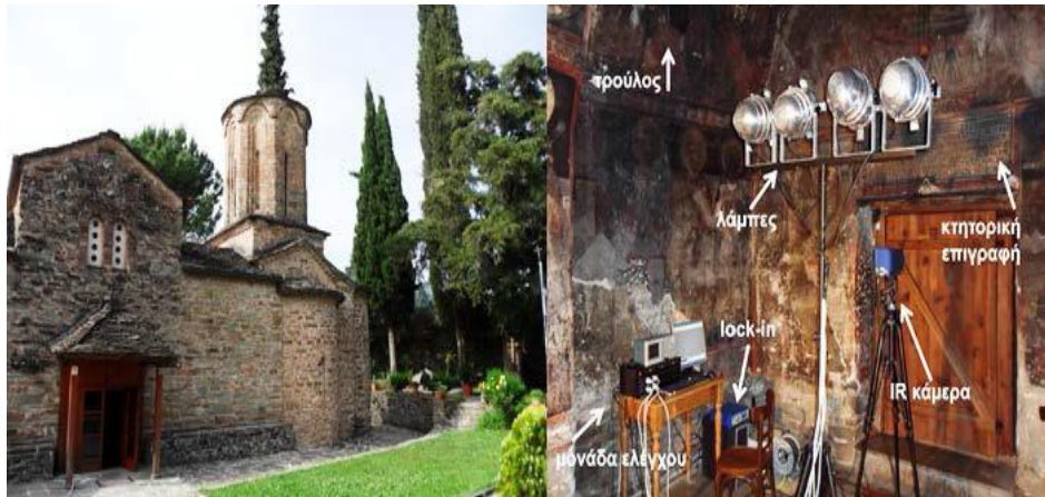
Εικόνα 12 Μονή Μολυβδοσκεπάστου και πειραματική διάταξη υπέρυθρης θερμογραφίας για την αξιολόγηση βλάβης στο εσωτερικό της Μονής [50].
