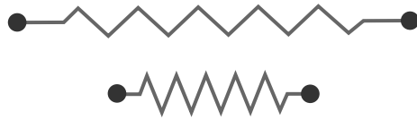
Εικόνα 11.1 ελατήριο σε εφελκυσμό και θλίψη
