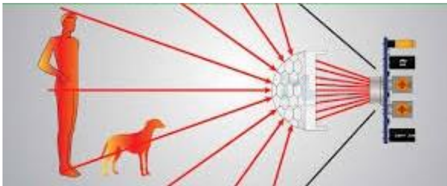
Εικόνα 4.19. Λειτουργία Αισθητήρα Παθητική Υπέρυθρης Ακτινοβολίας
