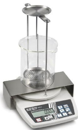
Εικόνα 2.3 Πειραματική διάταξη με το ζυγό ακριβείας και τον εξοπλισμό για την εύρεση της φαινόμενης πυκνότητας.
