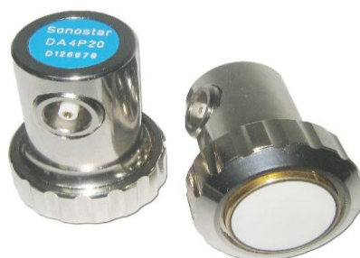
Εικόνα 1.14: Κάθετες κεφαλές υπερήχων μονού κρυστάλλου.
