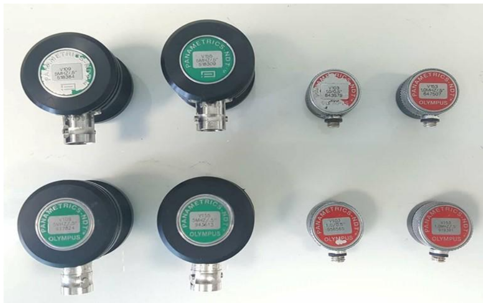
Εικόνα 2.10 Πιεζοηλεκτρικοί αισθητήρες Olympus 1MHz και 5MHz, διαμηκών και εγκάρσιων κυμάτων.
