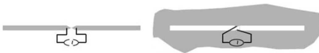
Σχήμα 2.12 Το δίπολο και η Σχισμοειδούς Ανοίγματος.
