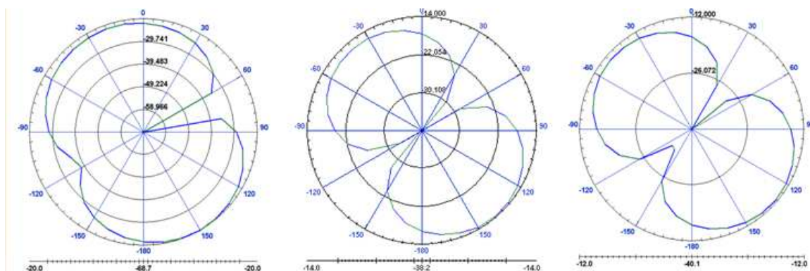
Σχήμα 3.7 Η απολαβή της κεραίας για C = 1, 2 και 3 pF.
