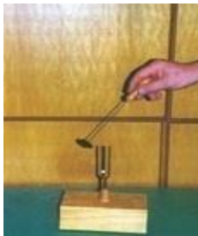
Εικόνα 18 Παραγωγή ηχητικών κυμάτων με διαπασών (πηγή: εικόνες Google)
