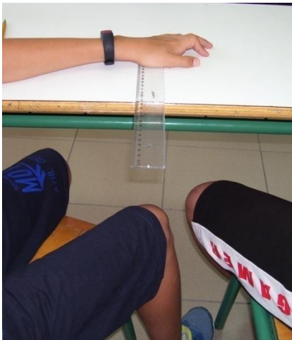
Εικόνα 20: Παραγωγή ηχητικών κυμάτων με χάρακα, πείραμα στην τάξη
